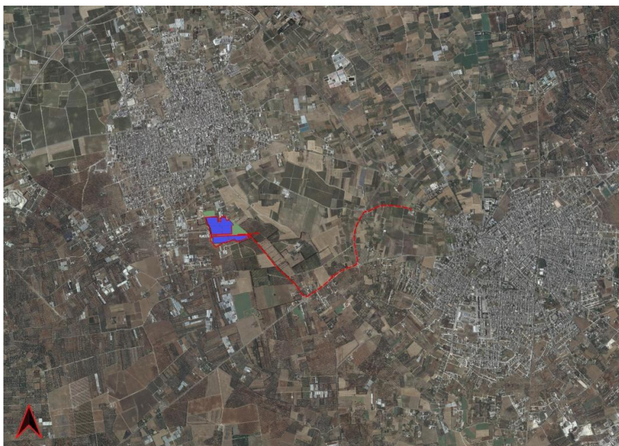
Figura 3 – collegamento alla cabina di consegna
