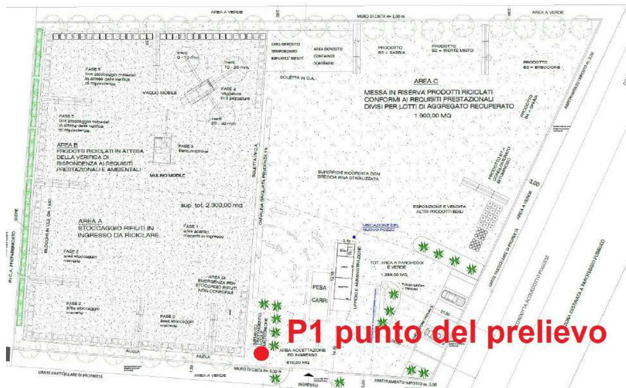
FIGURA 5 - Planimetria con ubicazione del punto di prelievo per il monitoraggio annuale delle acque meteoriche
