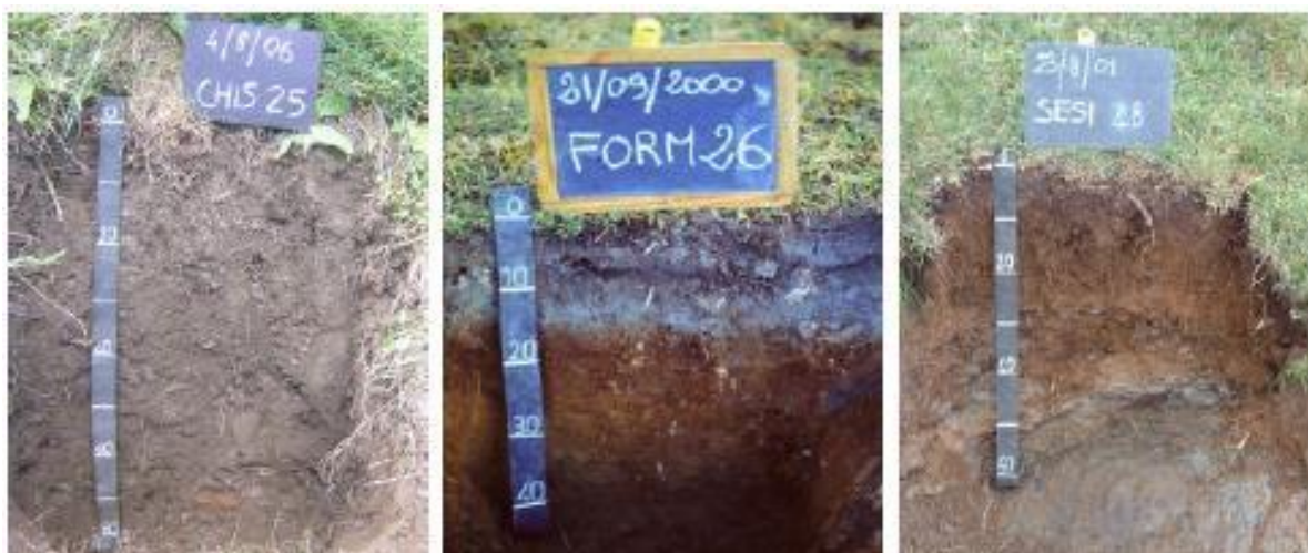
Figura 1-1-3: Esempi di scavi per rilevazione del profilo pedologico - (fonte "Capacità d'uso dei suoli a scala aziendale Allegato A" IPLA - Regione Piemonte)
