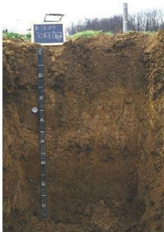
Figura 4-5: Esempi di profilo pedologico con suddivisione in orizzonti - (fonte "Capacità d'uso dei suoli a scala aziendale Allegato A" IPLA - Regione Piemonte)
