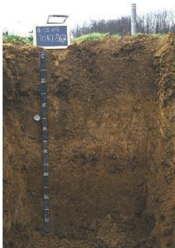
Figura 5-3: Esempi di profilo pedologico con suddivisione in orizzonti - (fonte "Capacità d'uso dei suoli a scala aziendale Allegato A" IPLA - Regione Piemonte)
