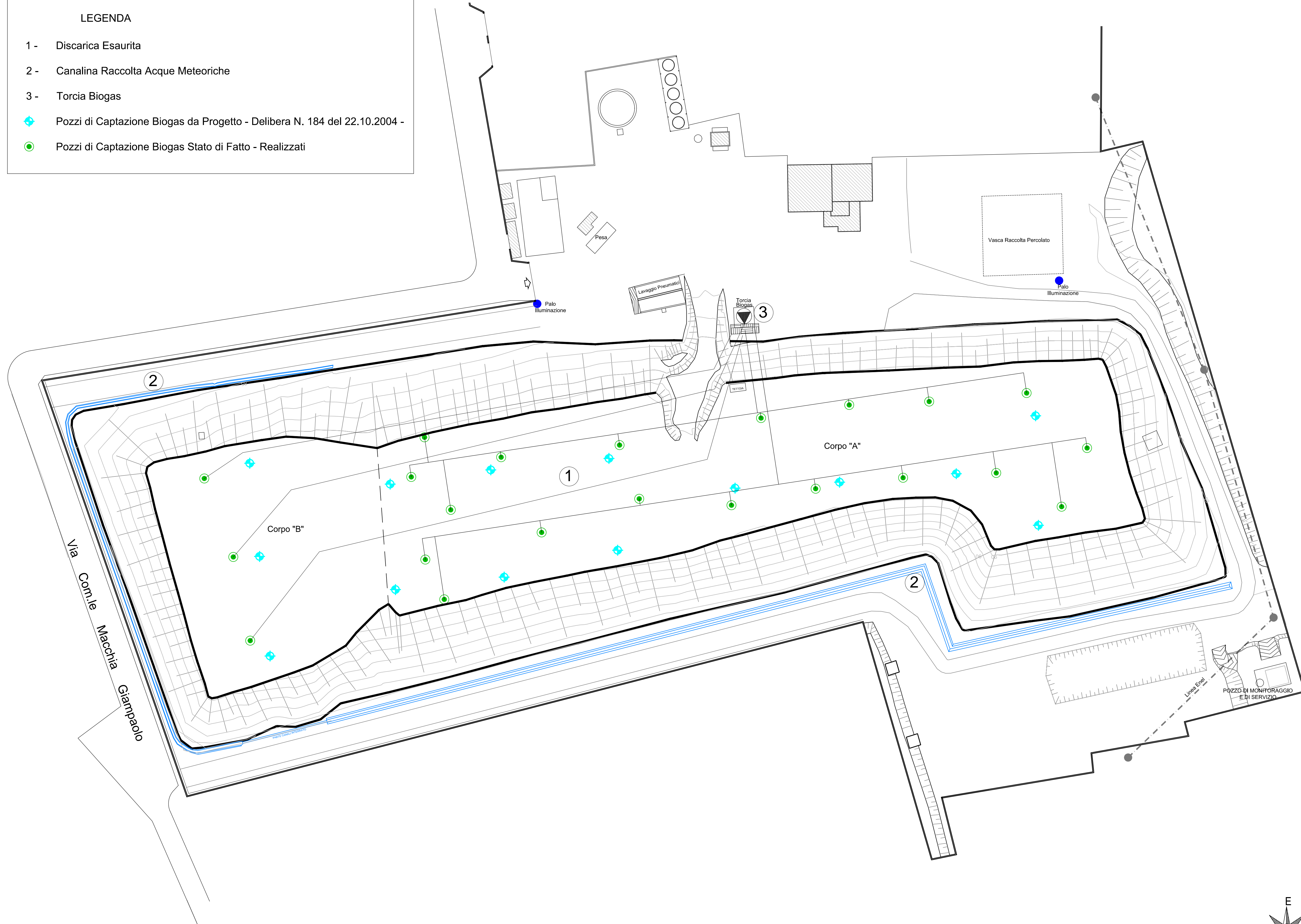
PLANIMETRIA GENERALE - Stato di Fatto Sistema di Captazione Biogas
