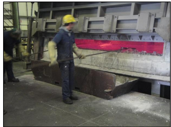
Fig. 1-17. Schiumatura del bagno
