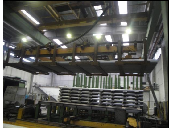
Fig. 1-25. Impilatore automatico billette
