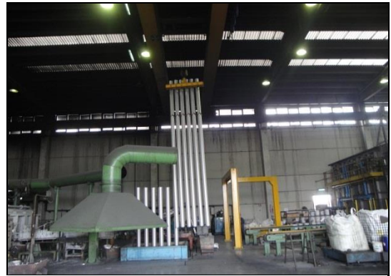
Fig. 1-21. Estrazione billette tramite gru a ponte
