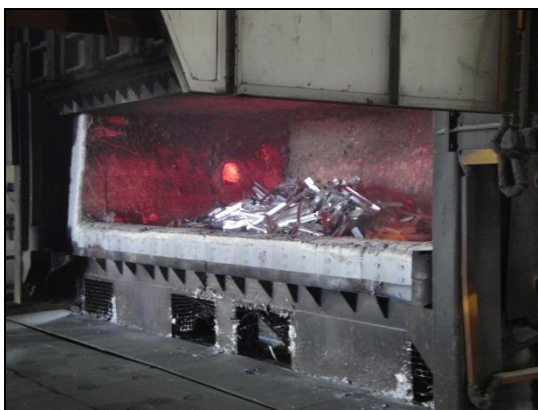
Fig. 1-1. Carica del forno fusorio
