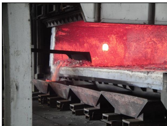
Fig. 1-13. Schiumatura del forno fusorio
