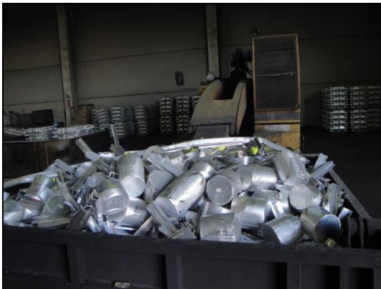
Fig. 1-6. Fondelli pressa da estrusione
