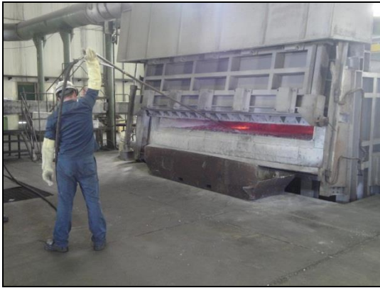
Fig. 1-16. Insuflaggio sali con azoto
