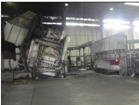
Fig. 1-14. Spillaggio in forno d'attesa
