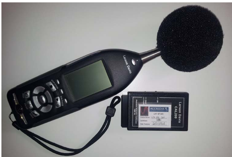
Figura 4: Fonometro e calibratore acustico Larson Davis
