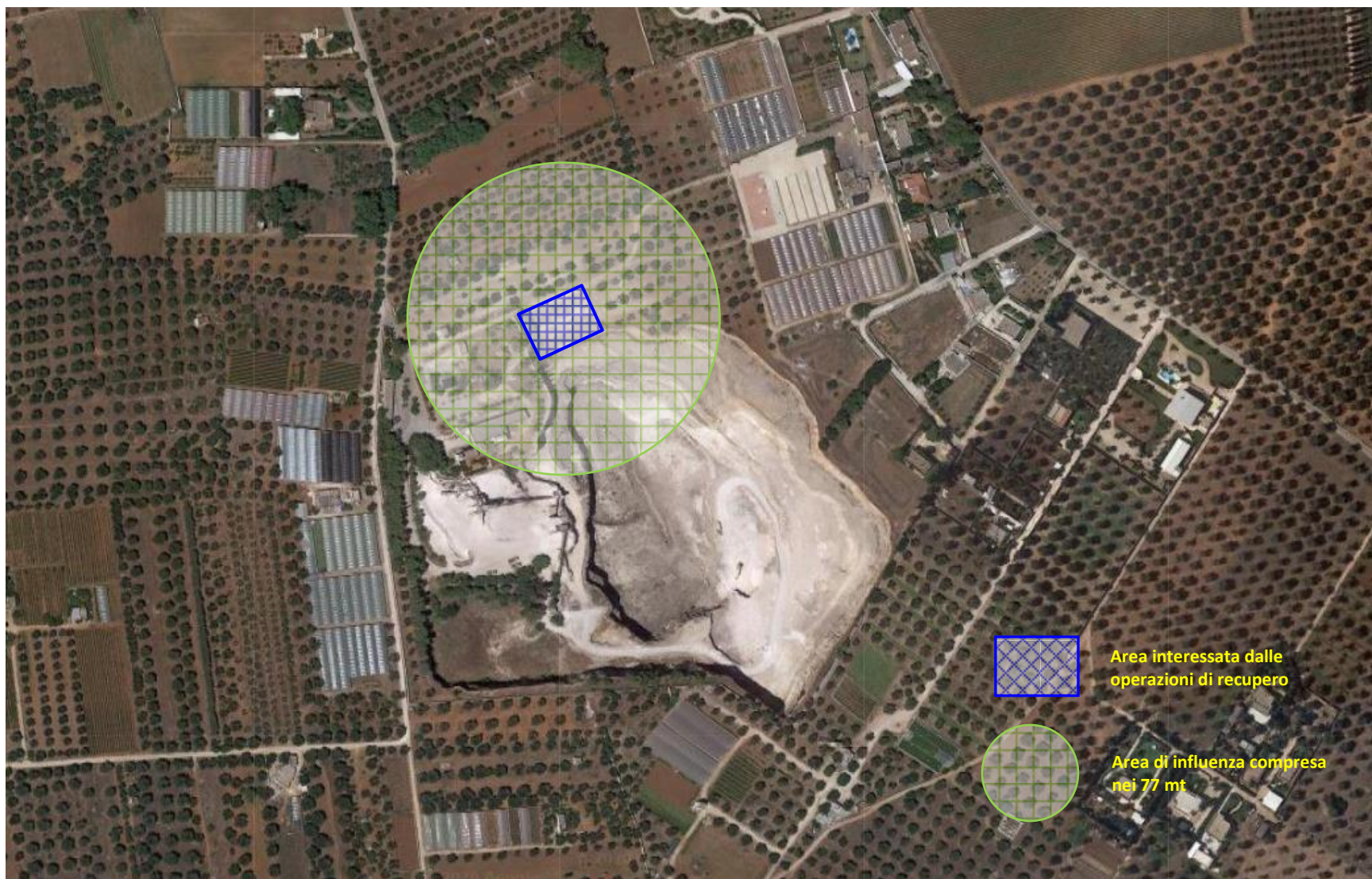
Fig. 6.5 : Fascia di influenza delle particelle sottili relativamente alla fase di cantiere
