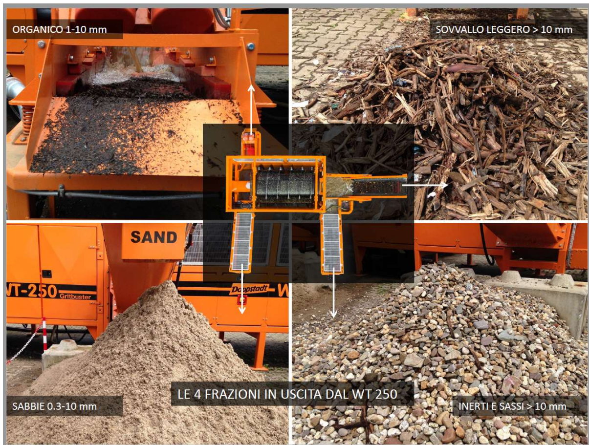
Figura 3.7- Schema di sintesi delle frazioni in uscita dal separatore WT 250
