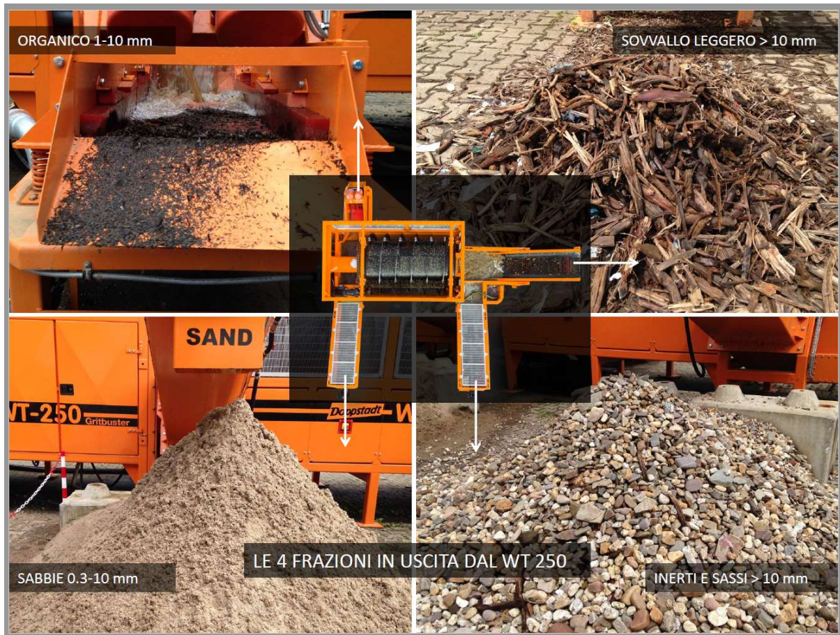
Figura 2.7- Schema di sintesi delle frazioni in uscita dal separatore WT 250
