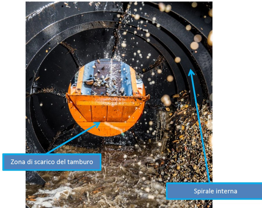
Figura 3.3 – Dettaglio dell'interno del tamburo di vagliatura. E' visibile la spirale interna atta a far avanzare il sovravvallo verso lo scarico (visibile al centro della foto).
