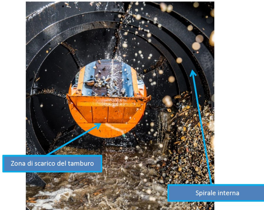
Figura 2.3 – Dettaglio dell'interno del tamburo di vagliatura. E' visibile la spirale interna atta a far avanzare il sovravvallo verso lo scarico (visibile al centro della foto).
