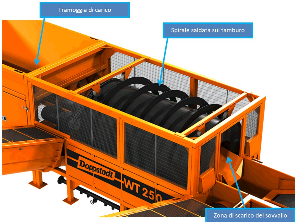
Figura 3.2 – Particolare della spirale sul tamburo
