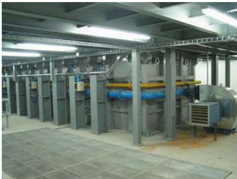
Figura 12 - Forno sottoposto al piano di calpestio contenente la vasca di zinco
