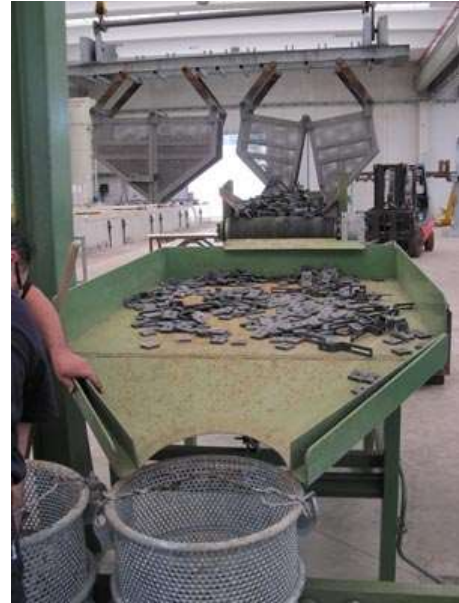
Figura 17 - Banco di carico con tramoggia e cestelli
