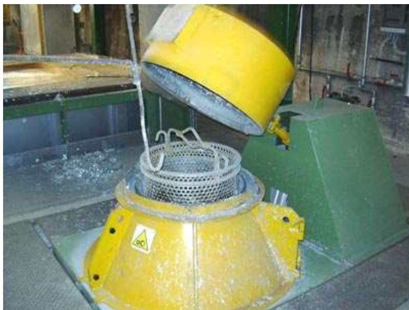
Figura 21 – Centrifuga del cestello con minuteria zincata
