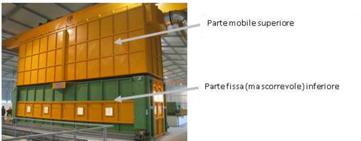
Figura 14 – Cappa di aspirazione fumi bianchi di zincatura
