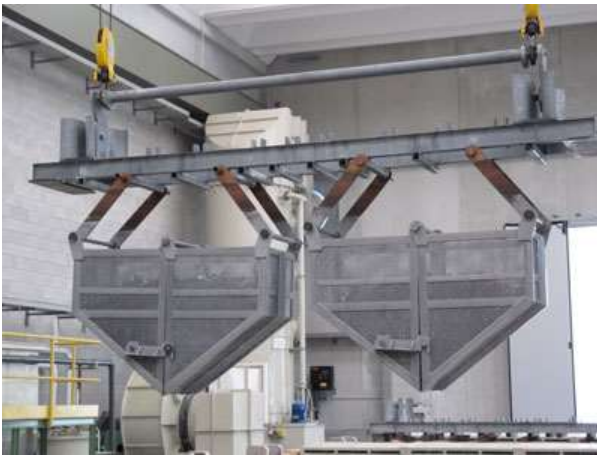
Figura 16 - Cestelli per il pretrattamento della minuteria
