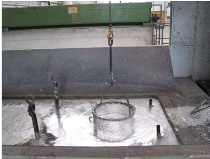
Figura 20 – Immersione del cestello con minuteria nella vasca di zincatura
