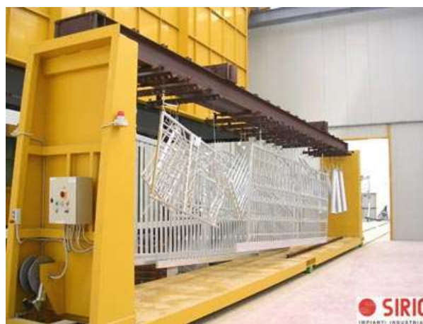
Figura 4 – Carro trasferitore con telai carichi
