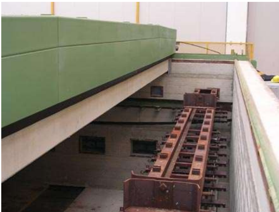
Figura n. 11 - Forno di preriscaldamento o fossa di essiccazione
