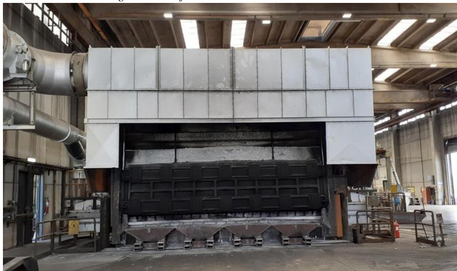
Fig.10 - Forno fusorio monocamera da 25 tonnellate
