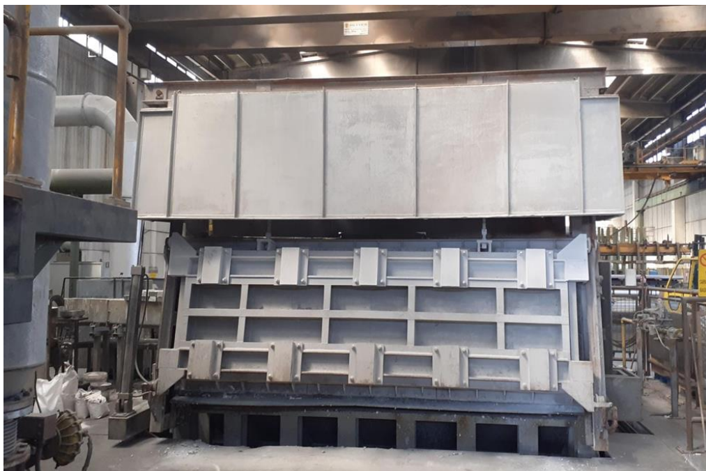
Fig.11 - Forno di attesa da 14 tonnellate
