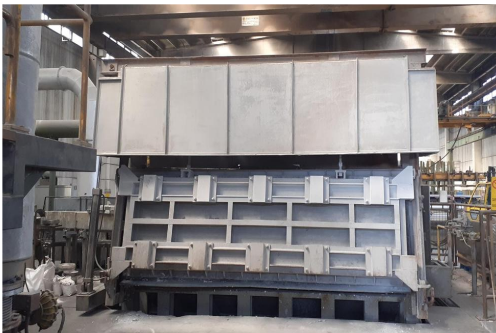
Fig.11 - Forno di attesa da 14 tonnellate
