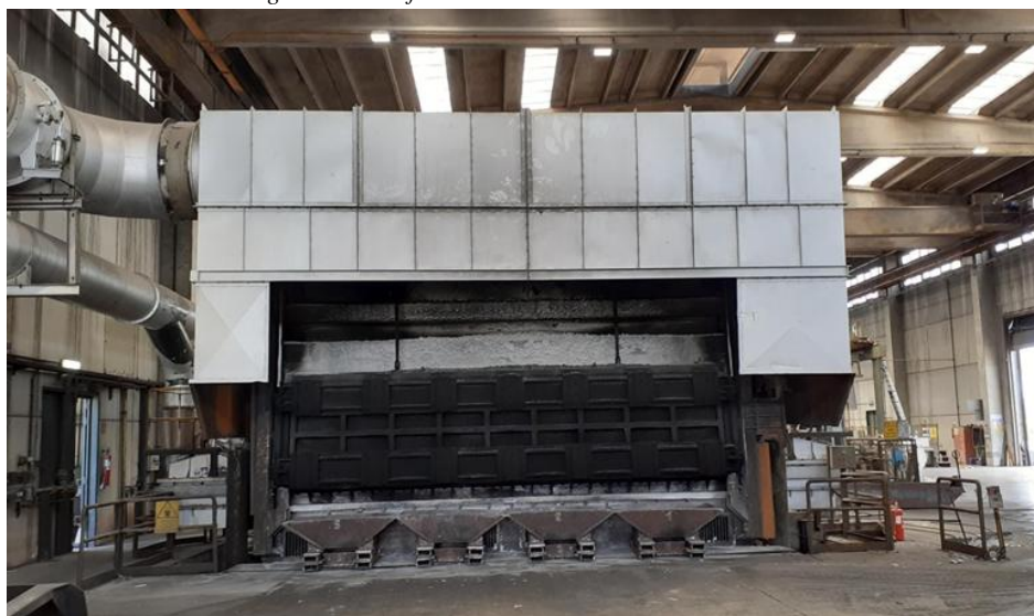
Fig.10 - Forno fusorio monocamera da 25 tonnellate
