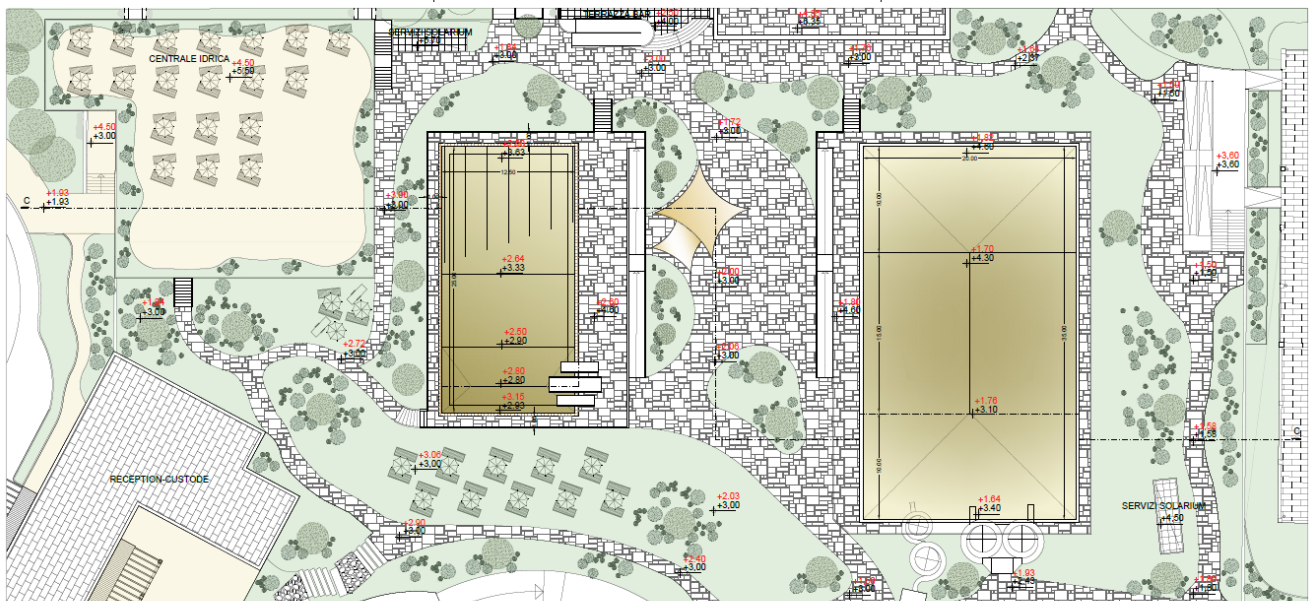
PLANIMETRIA GENERALE - SCALA 1:200 (in rosso le quote del piano di campagna, in nero quelle di progetto)
