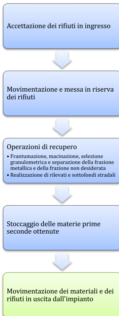
Figura 1-3: Schema a blocchi del processo di recupero dei rifiuti speciali inerti non pericolosi
