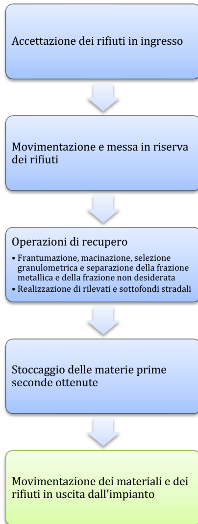
Figura 2-5: Schema a blocchi del processo di recupero dei rifiuti speciali inerti non pericolosi
