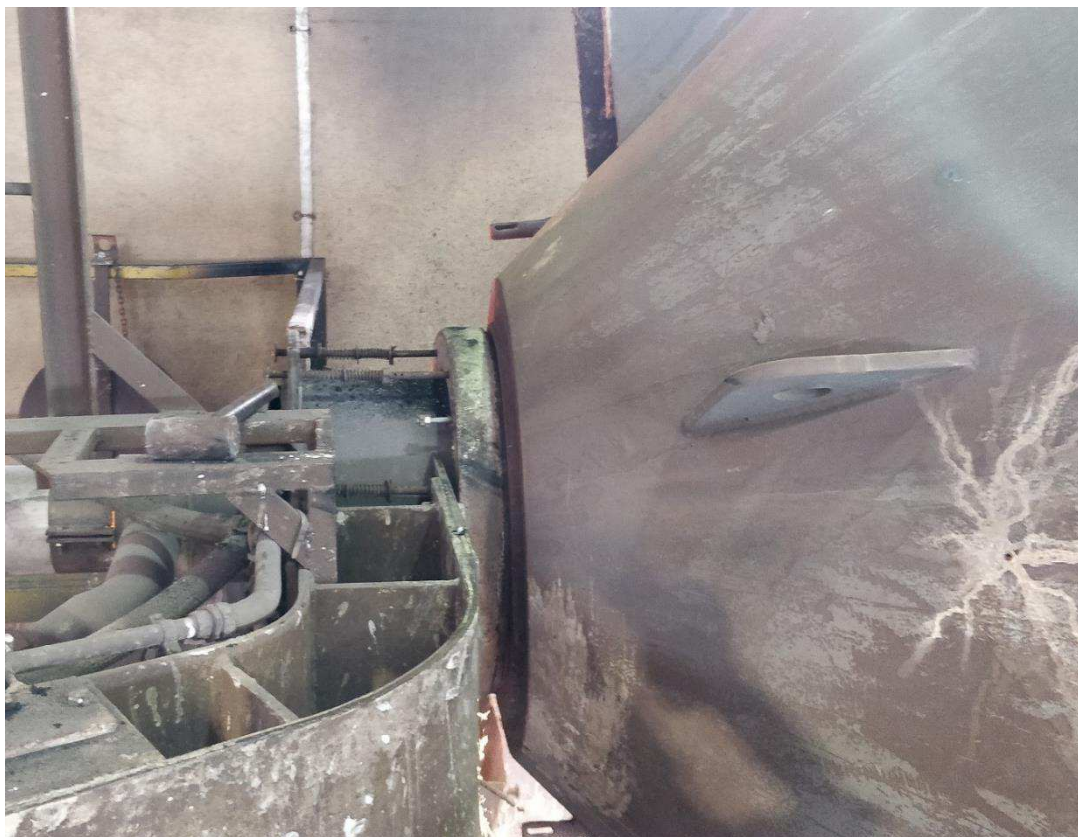
Fig. 6 – Particolare aggancio bruciatore-forno rotante
