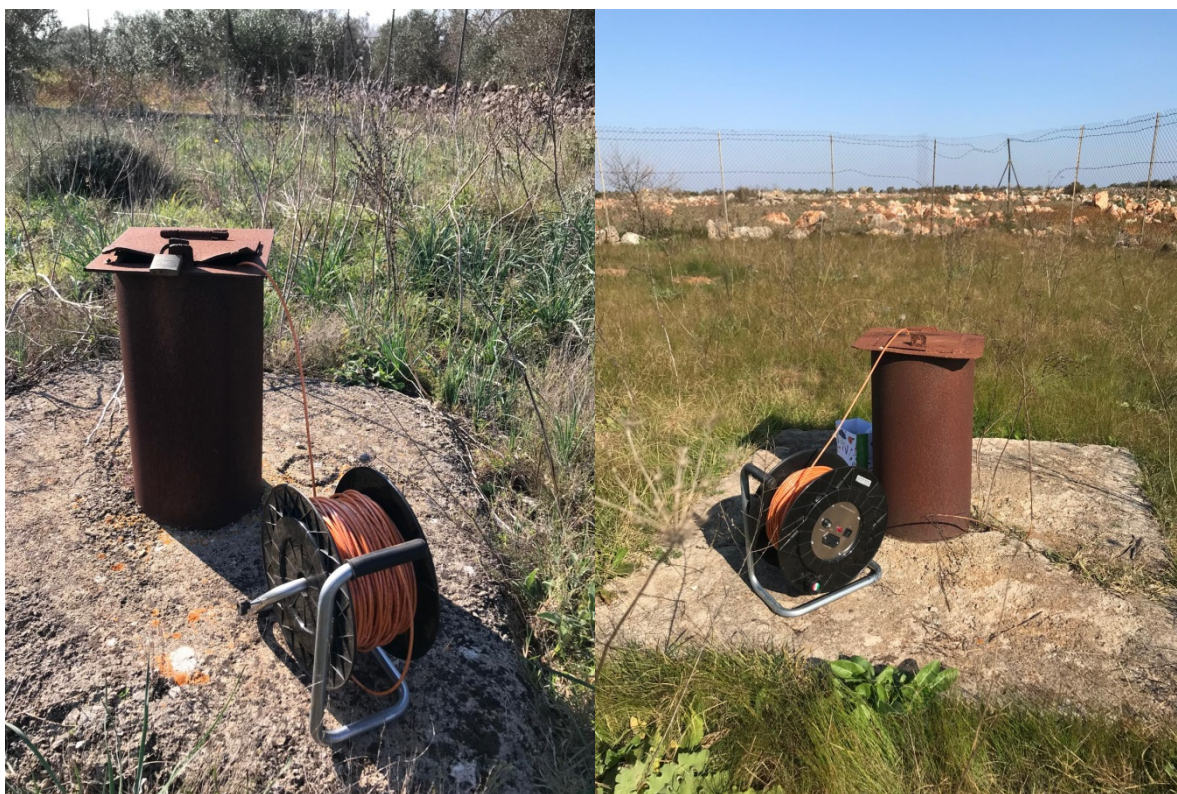
Foto 16 e 17 – Misure piezometriche nei pozzi n. 9 e 10 (11/11/2024)
