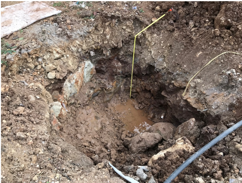
Foto 5- Prova di permeabilità a carico variabile in pozzetto – pozzetto vuoto dopo 130 minuti
