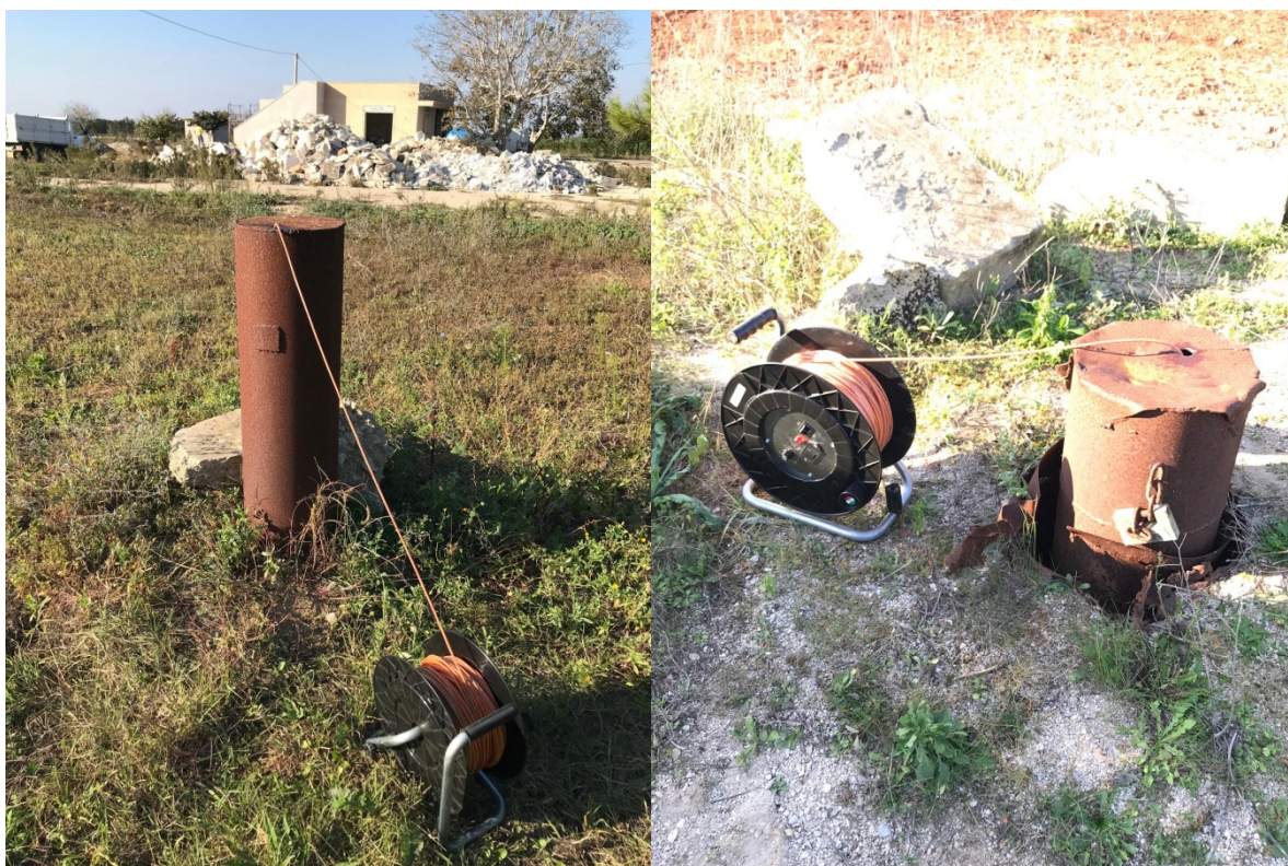
Foto 12 e 13 – Misure piezometriche nei pozzi n. 5 e 6 (11/11/2024)
