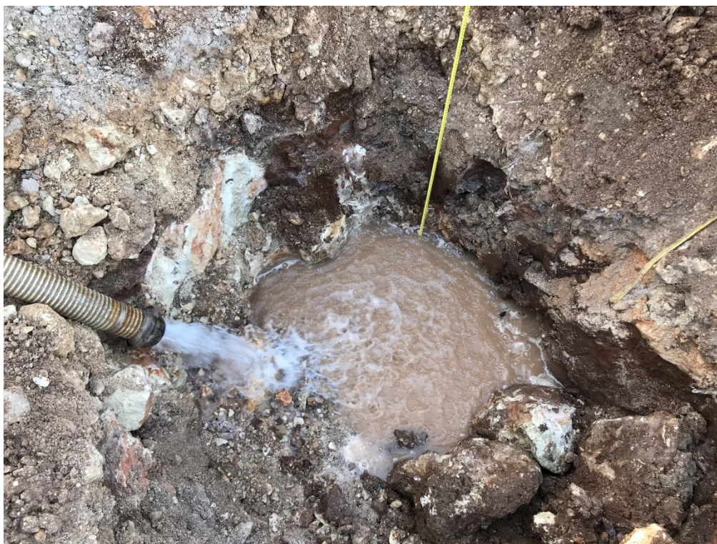
Foto 3- Prova di permeabilità a carico variabile in pozzetto - riempimento
