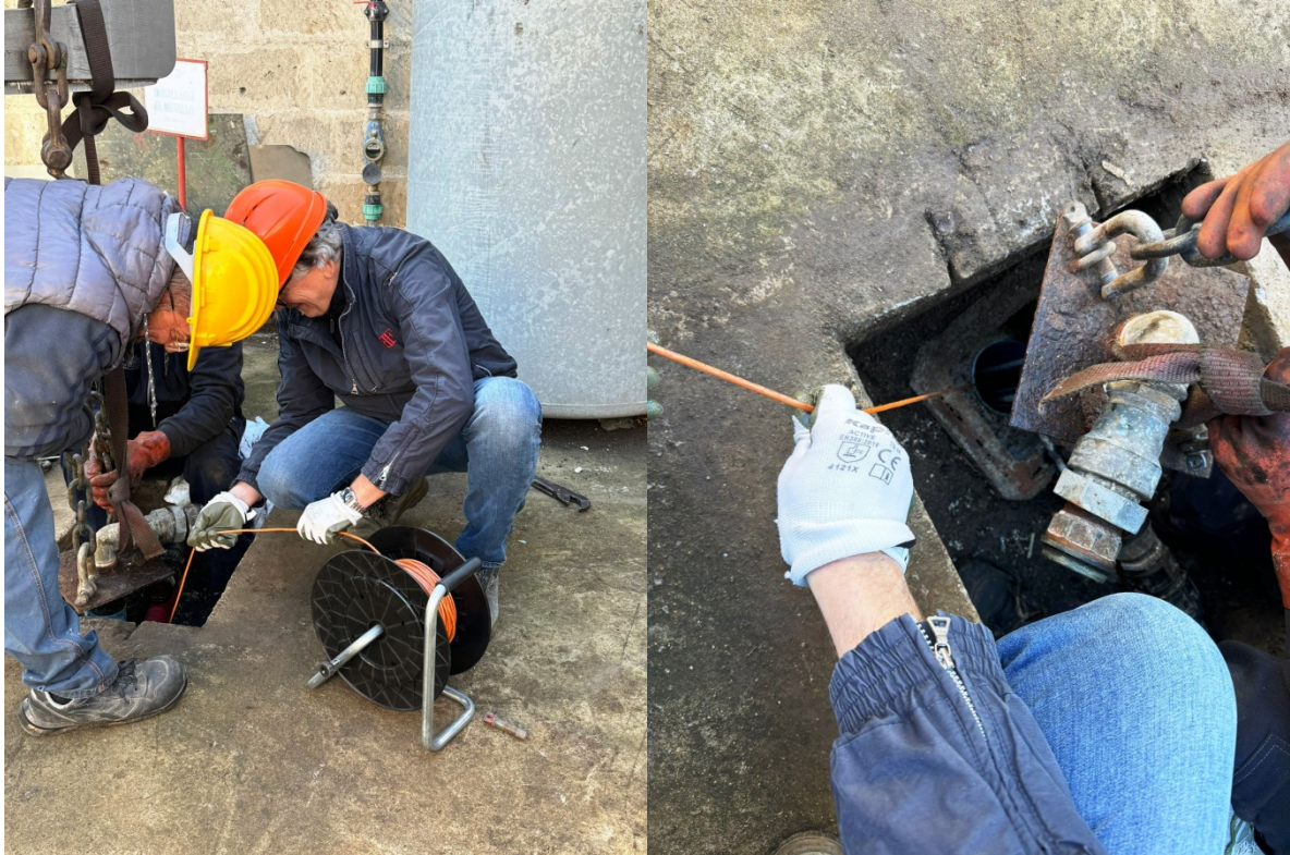
Foto 6 e 7 – Misura piezometrica nel pozzo aziendale ( Pozzo n. 12 - 11/11/2024)
