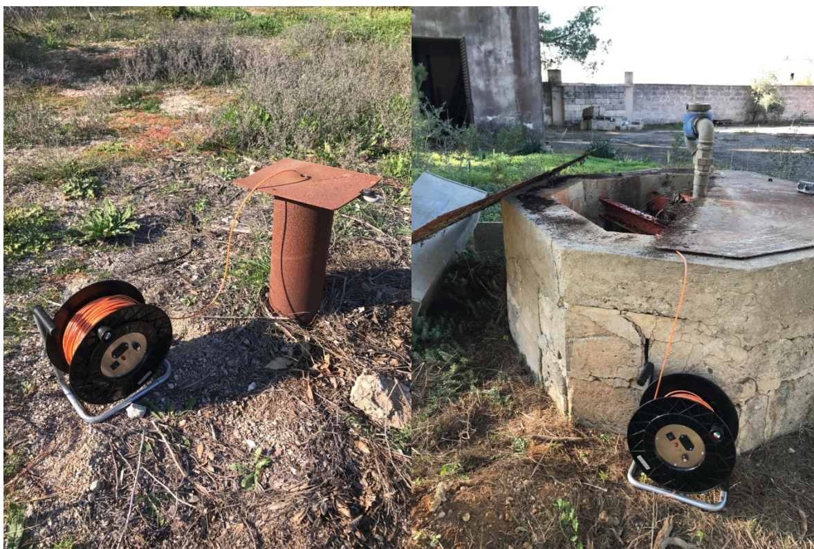
Foto 8 e 9 – Misure piezometriche nei pozzi n. 1 e 2 (11/11/2024)
