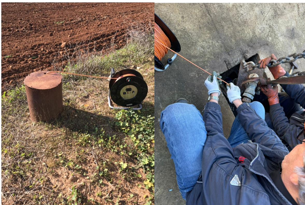
Foto 18 e 19 – Misure piezometriche nei pozzi n. 11 e 12 (11/11/2024)
