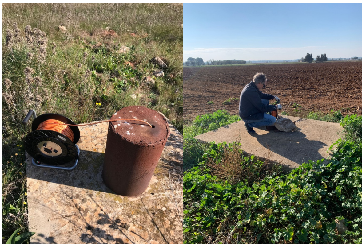
Foto 10 e 11 – Misure piezometriche nei pozzi n. 3 e 4 (11/11/2024)
