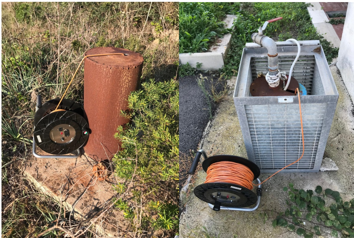
Foto 14 e 15 – Misure piezometriche nei pozzi n. 7 e 8 (11/11/2024)
