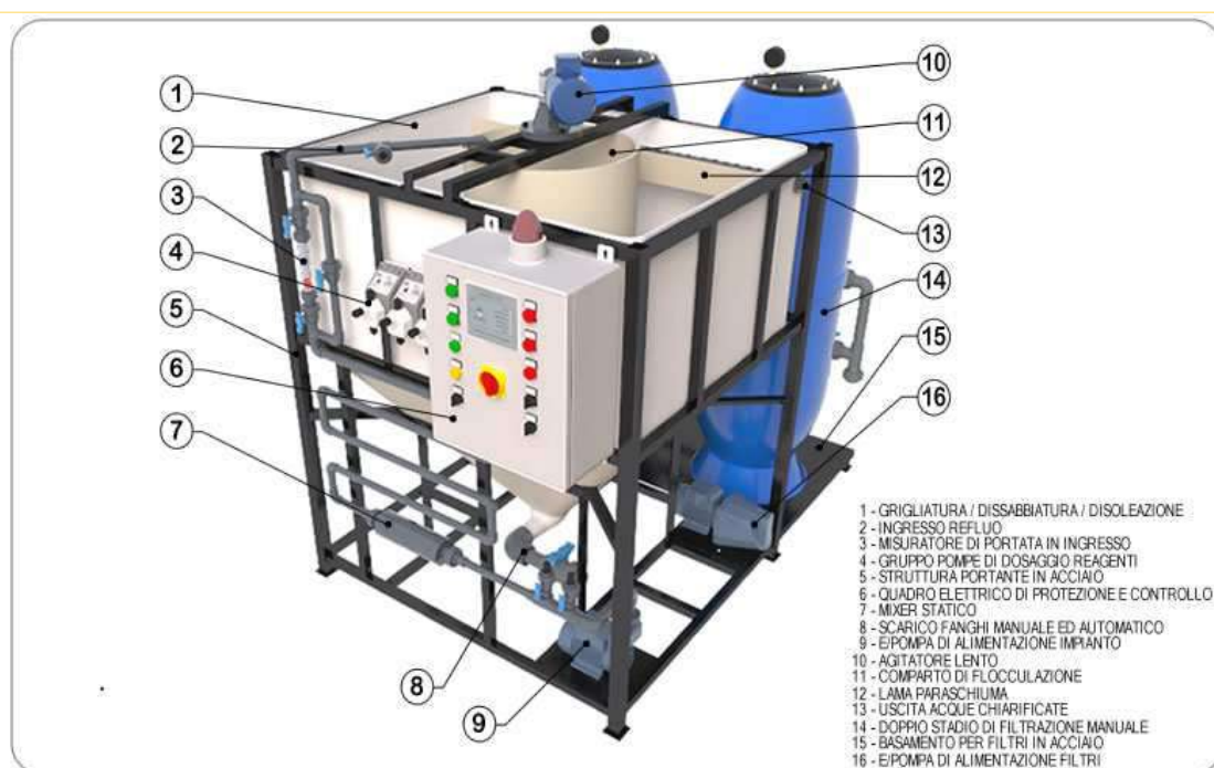
Fig. 23 – Unità di trattamento di tipo chimico - fisico
