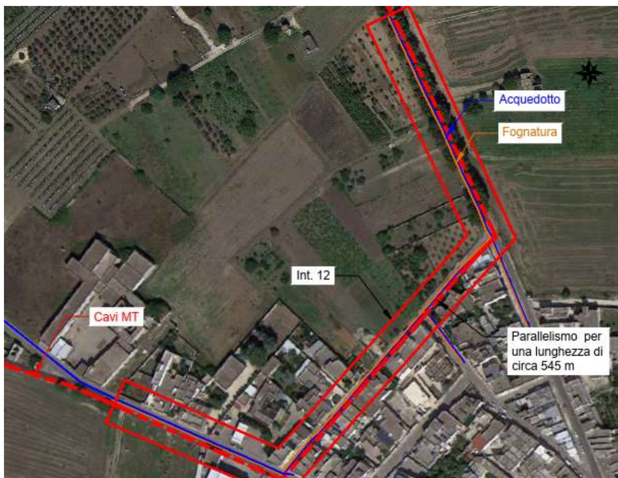
Figura 4.1: interferenze cavidotto con servizi interrati
