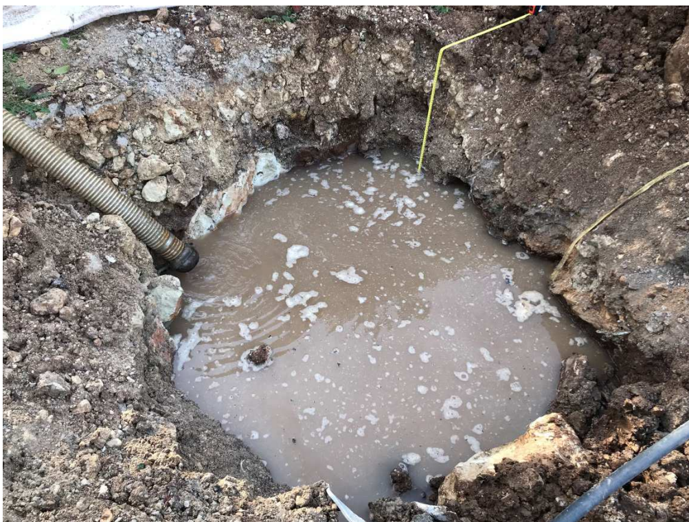
Foto 4- Prova di permeabilità a carico variabile in pozzetto -
