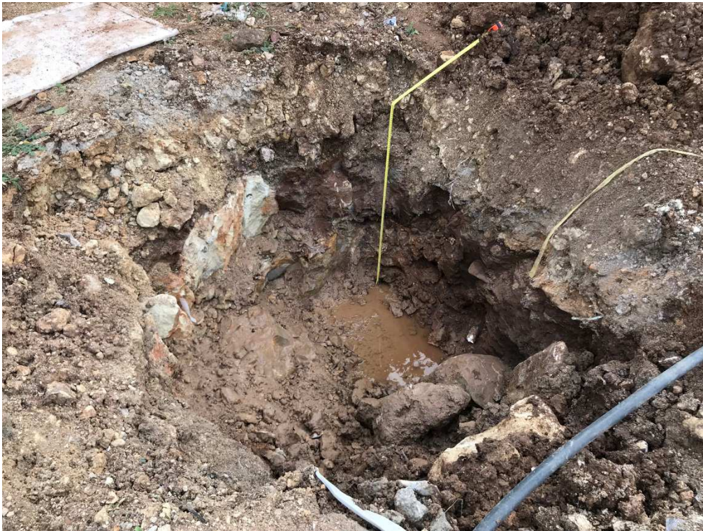
Foto 4- Prova di permeabilità a carico variabile in pozzetto – pozzetto vuoto dopo 130 minuti
