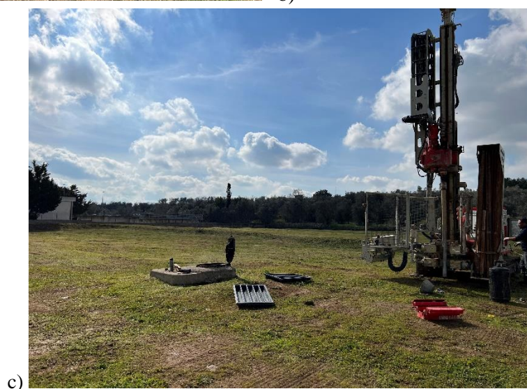
Figura 15 – a) esecuzione di sondaggi geognostici; b) esecuzione di prove fonometriche; c) esecuzione di prove di permeabilità in foro a carico variabile
