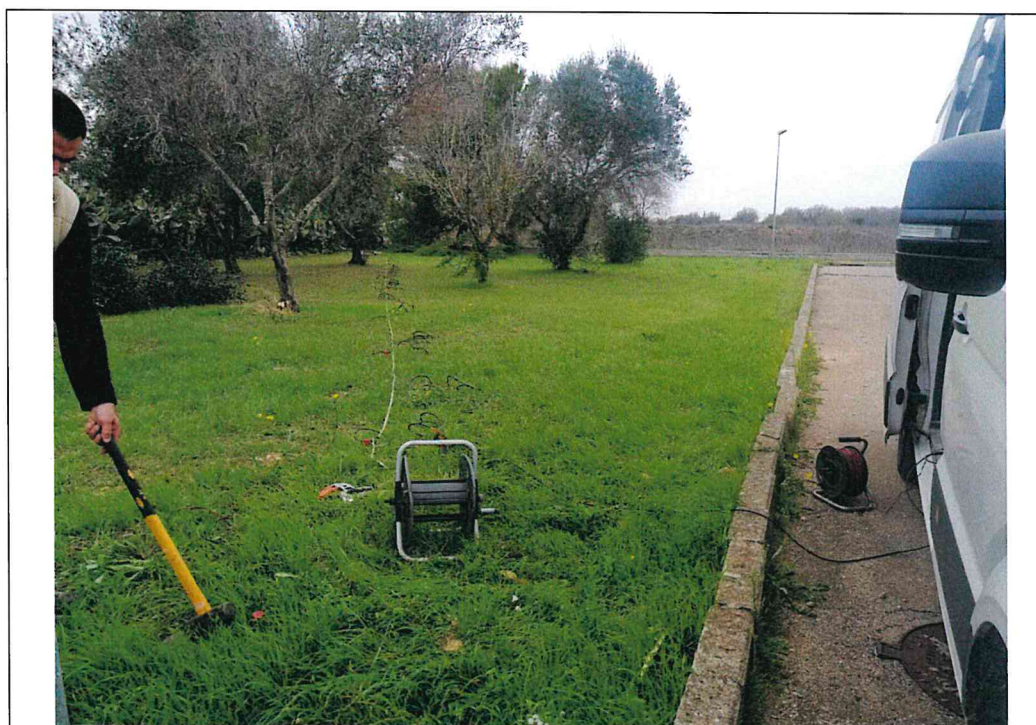
Esecuzione profilo sismico a rifrazione 4-4' e Masw sullo stesso stendimento
