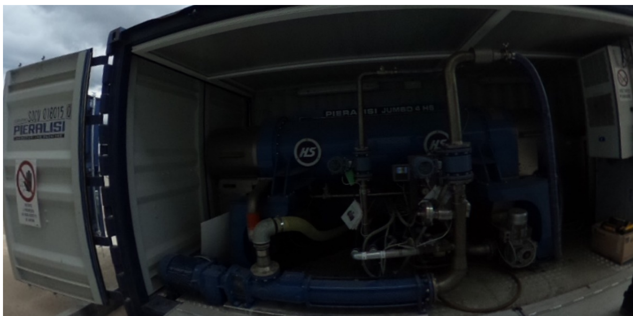
Figura 33 – Sistema mobile di disidratazione fanghi
