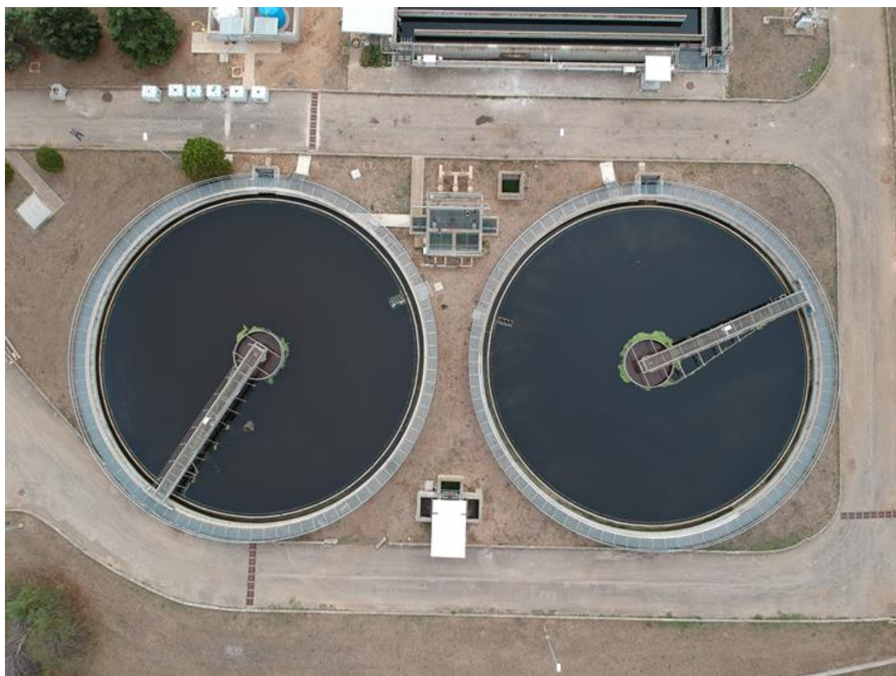
Figura 14 – Foto aerea – comparto di sedimentazione secondaria
