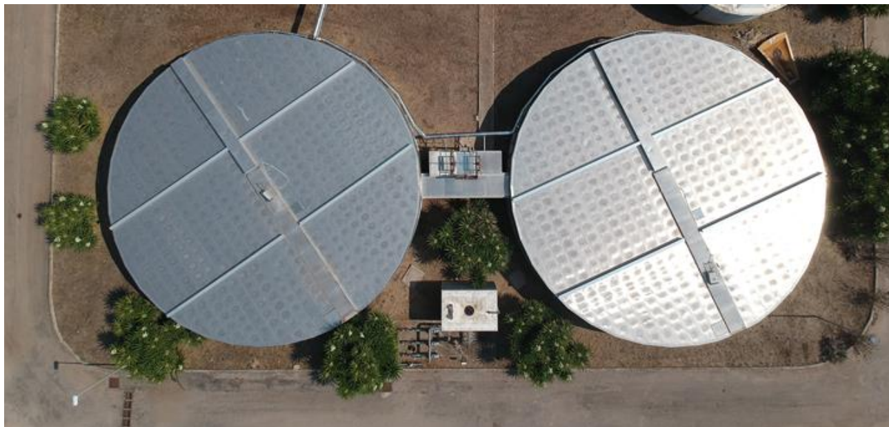
Figura 9 – Foto aerea – comparto sedimentazione primaria
