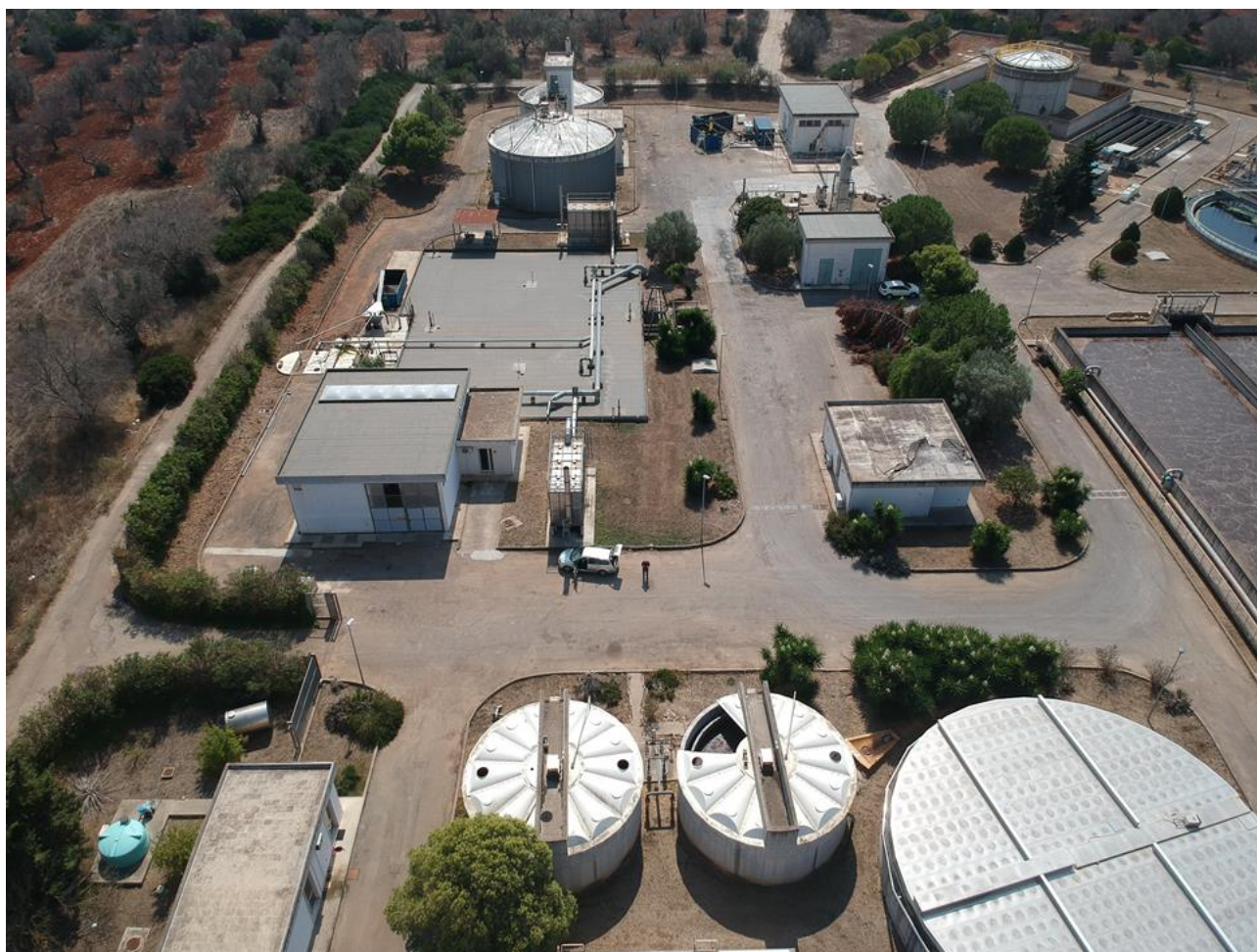
Figura 8 – Visione di insieme dell'impianto – zona ingresso-pre-trattamenti-equalizzazione
