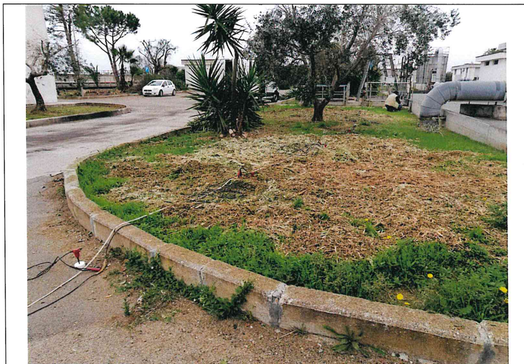
Esecuzione profilo sismico a rifrazione 1-1' e Masw sullo stesso stendimento
