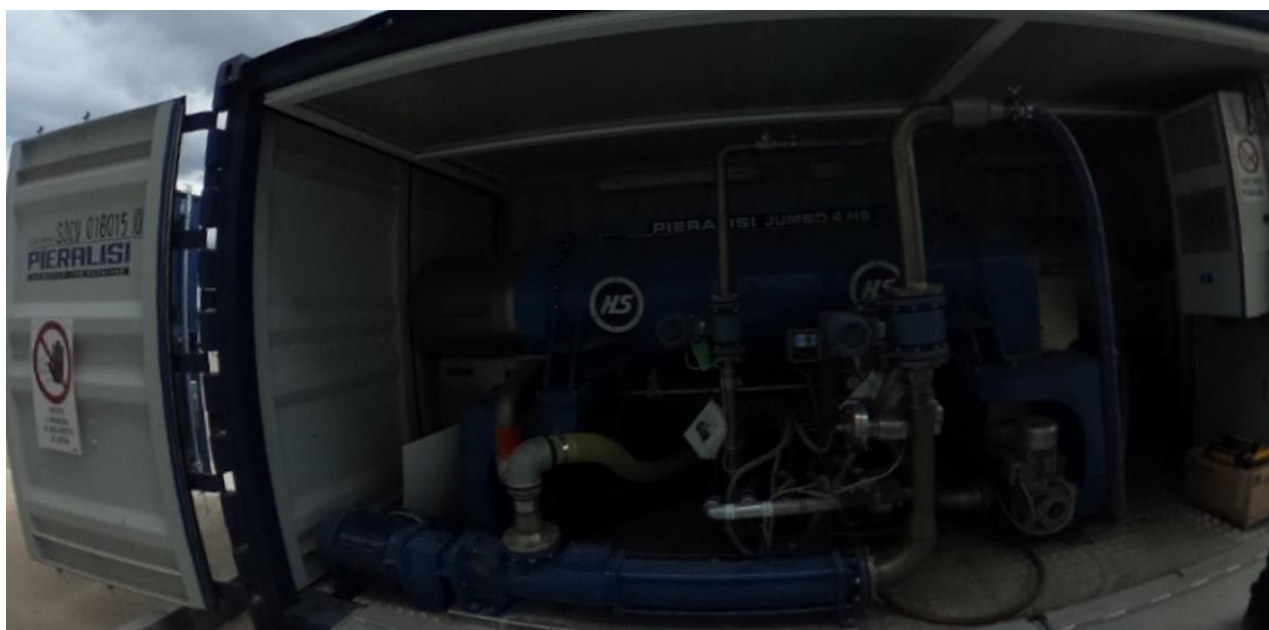
Figura 26 – Sistema mobile di disidratazione fanghi
