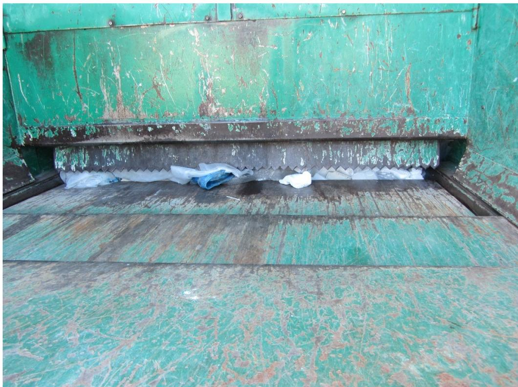
Esempio di compattatore scarrabile a cassetto
