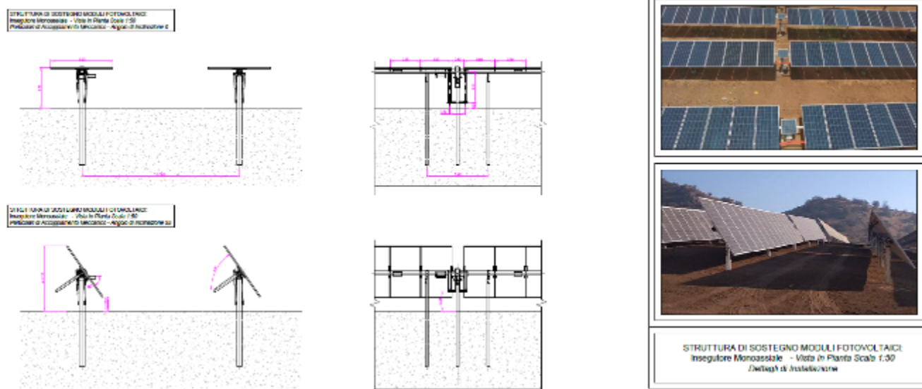
Fig.3.7: Particolari strutturali trackers monoassiali
