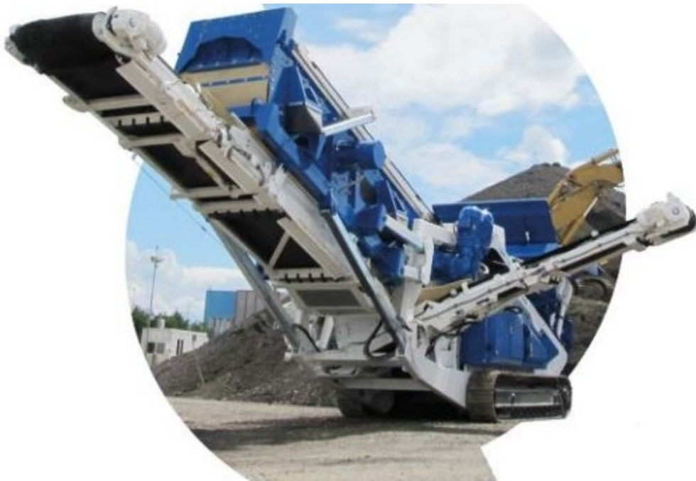
Figura 5 Trituratore con motore a combustione interna e cingoli per mobilità
