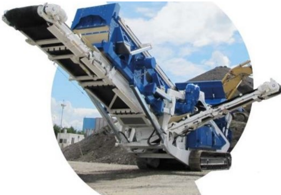
Figura 5 Trituratore con motore a combustione interna e cingholi per mobilità
