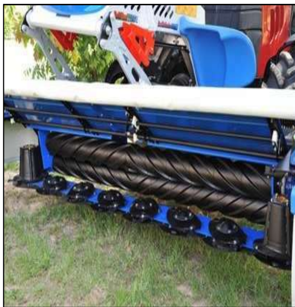
Esempio di falciacondizionatrice frontale e particolare dei rulli in gomma (Foto: BCS)
