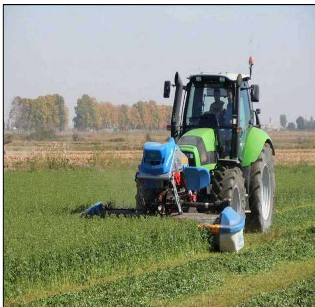
Esempio di falciacondizionatrice frontale e particolare dei rulli in gomma (Foto: BCS)
