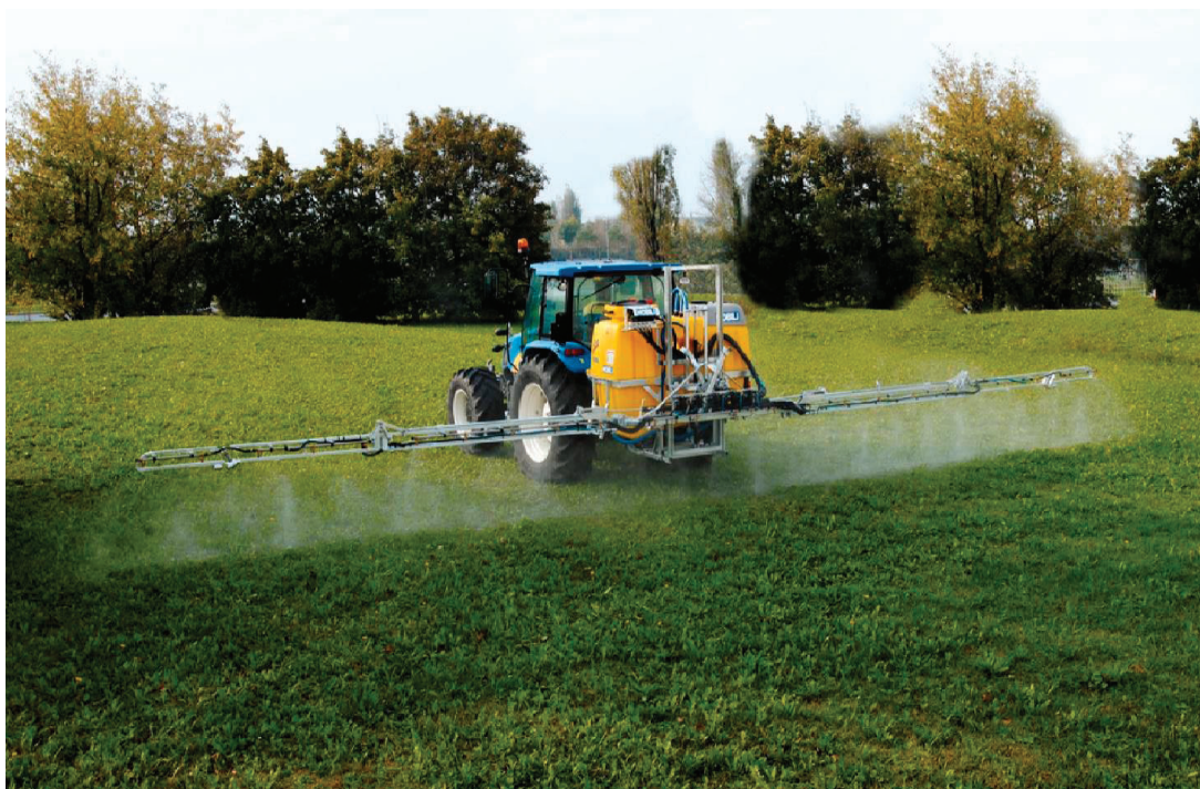
Figura 8 Barra irroratrice con ugelli antideriva
