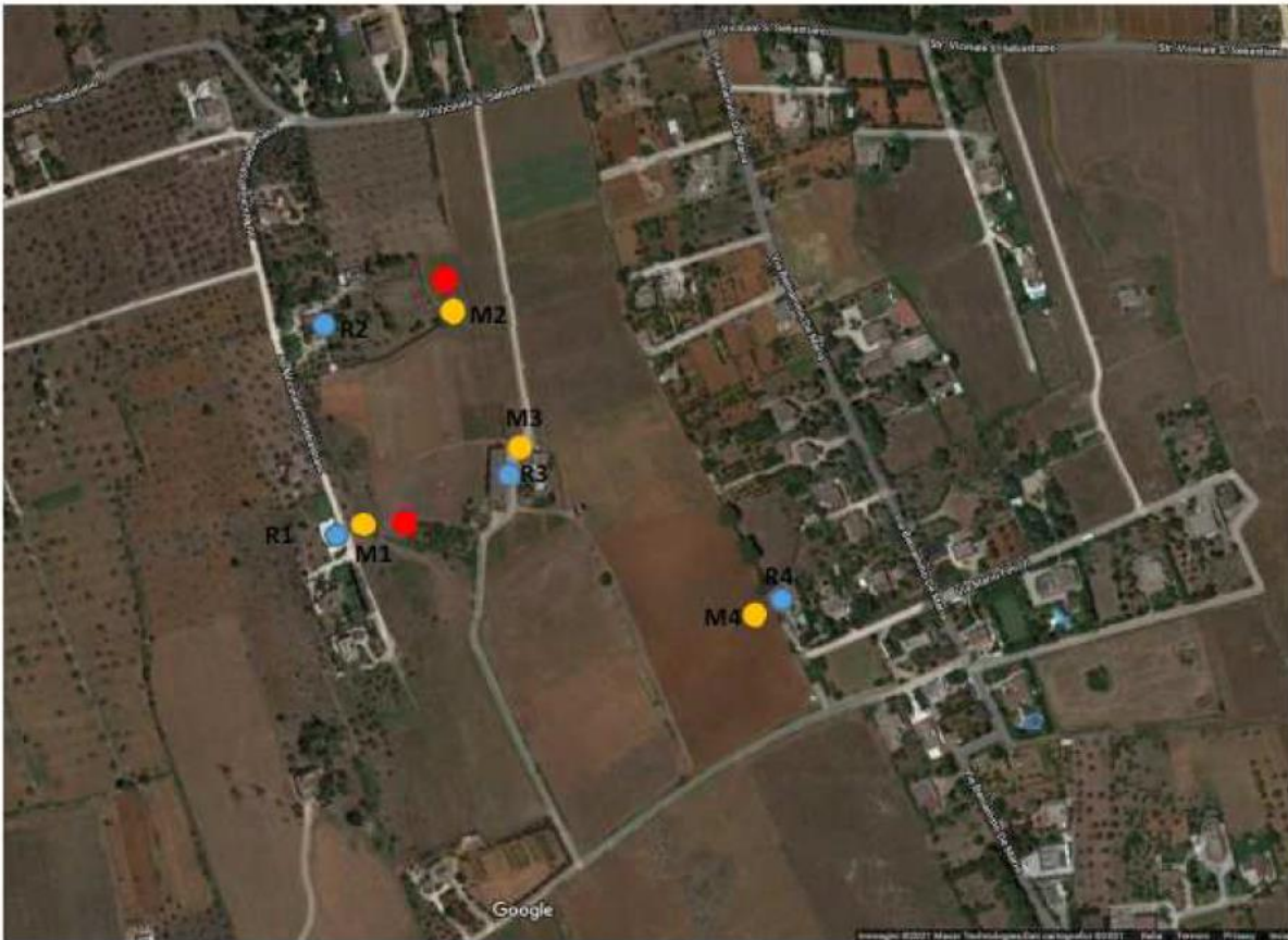
Indicazione dei ricettori (pallini azzurri), delle cabine inverter / trasformazione BT/MT (pallini rossi), dei punti di misurazione di Leq(A) (pallini gialli)
