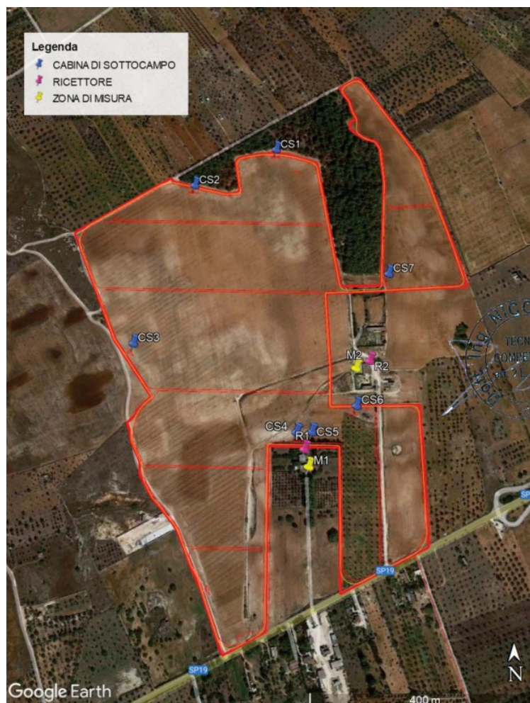
Figura 5 - Planimetria generale zona parco fotovoltaico - Individuazione cabine di sottocampo, ricettori e zone di misura
