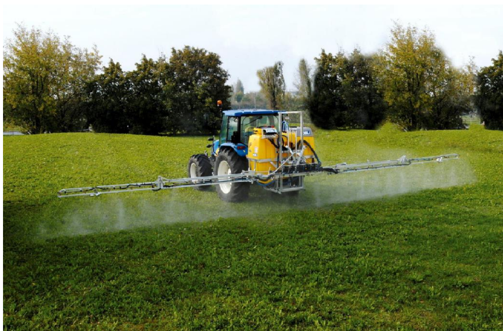
Figura 8 Barra irroratrice con ugelli antideriva
