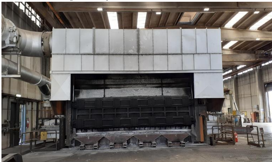
Fig.10 - Forno fusorio monocamera da 25 tonnellate
