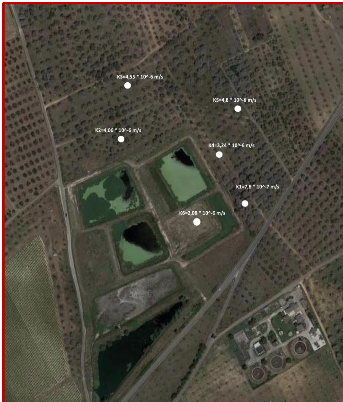
Figura 4-Permeabilità idraulica rilevata nelle prove effettuate nel marzo 2021
