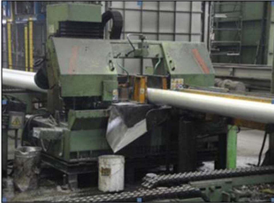
Fig.12 – Impianto spuntatura billette
