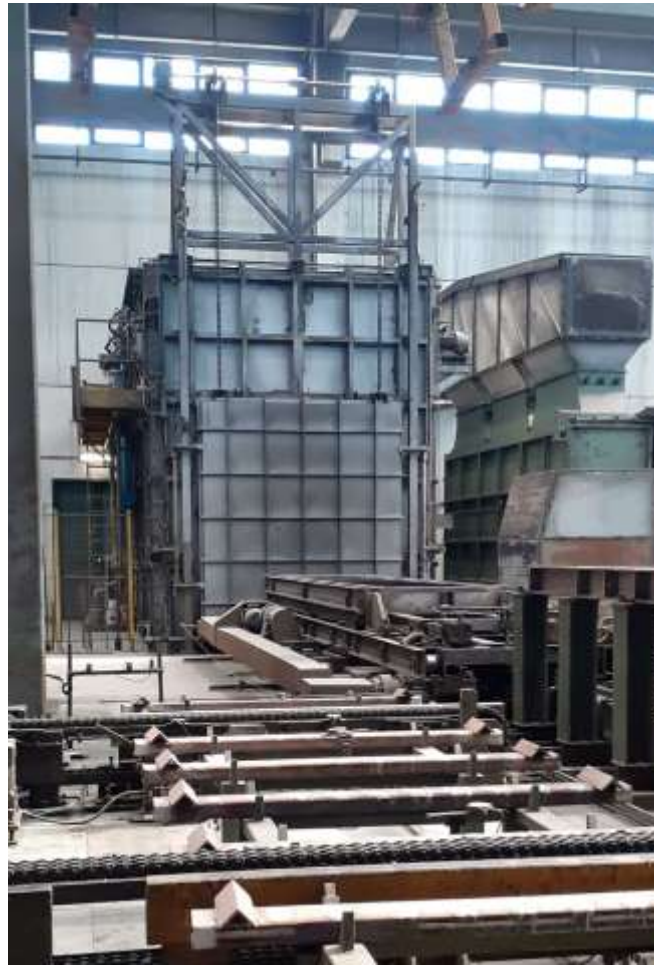
Fig.13 – Forno di omogeneizzazione
