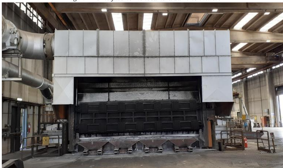
Fig.10 - Forno fusorio monocamera da 25 tonnellate
