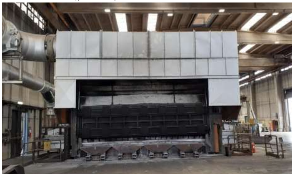
Fig.10 - Forno fusorio monocamera da 25 tonnellate
