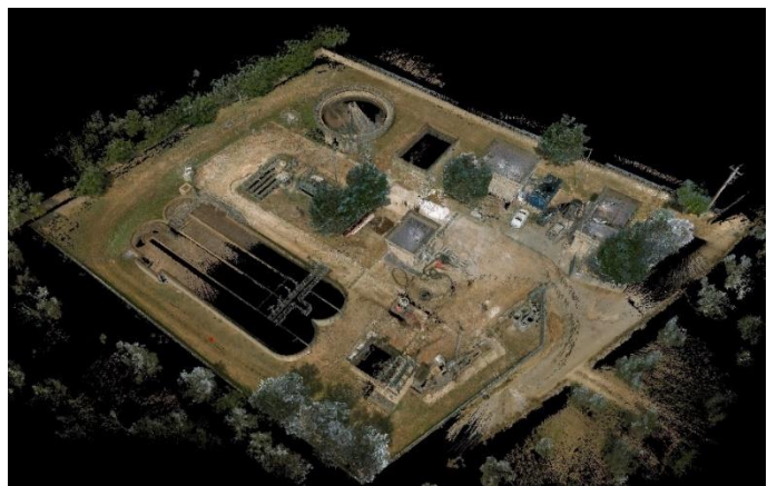
Figura 13 – Esecuzione di rilievi topografici (a) e laser scanner (b) su drone presso l'IDA di Collepasso
