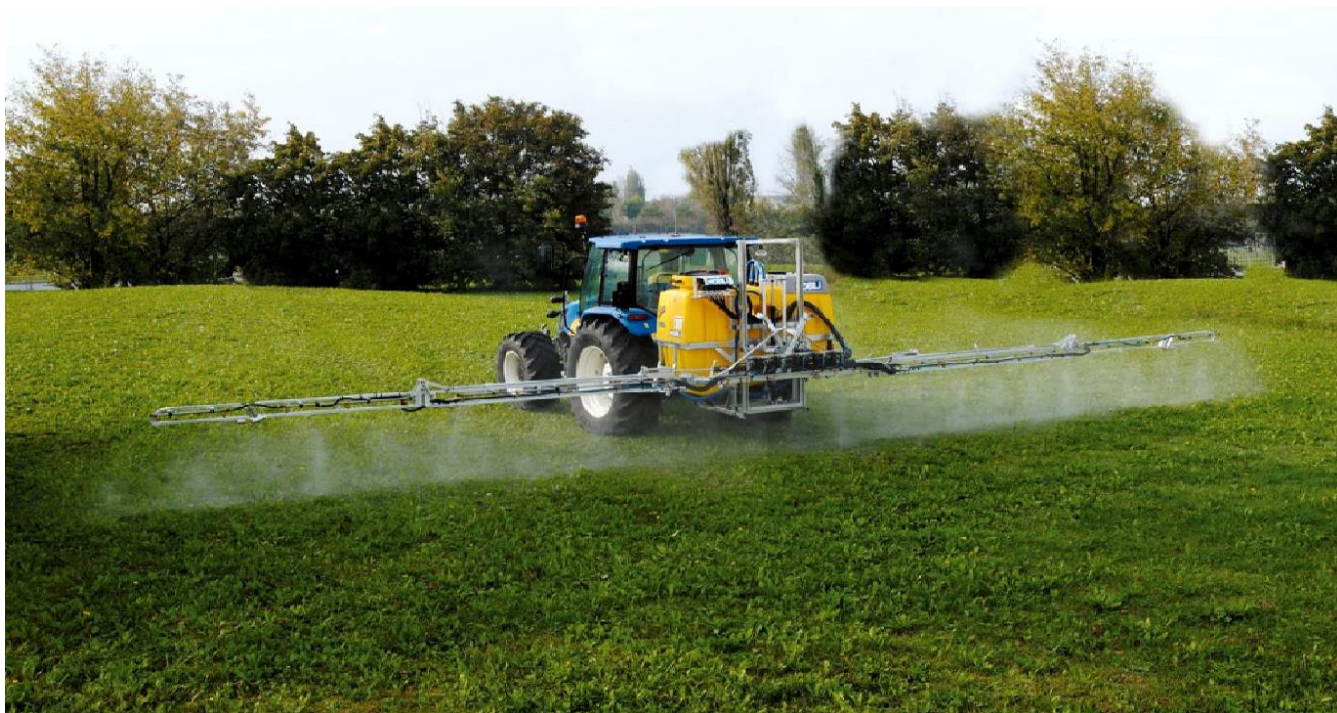
Figura 8 Barra irroratrice con ugelli antideriva
