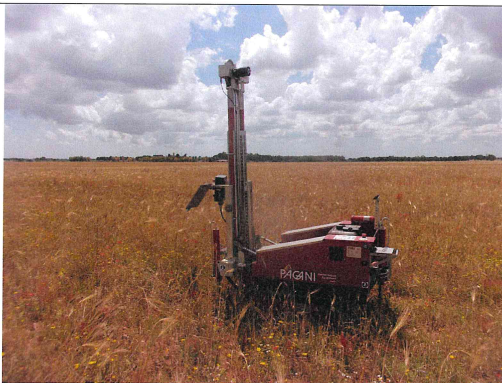
Esecuzione prova DPSH 1
