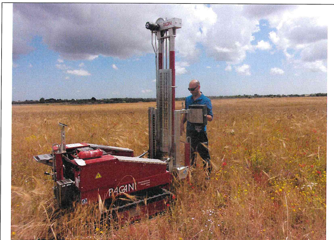
Esecuzione prova DPSH 3
