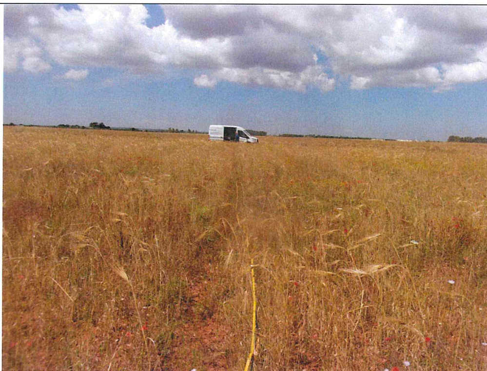
Esecuzione indagine sismica a rifrazione n. 1
