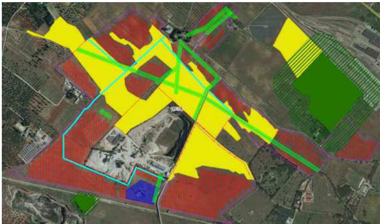
Figura: Layout su PPTR approvato (Rif. Relazione Piano Integrato agrovoltaiico" (pag. 3-4 ): in giallo l'area sottoposta a vincolo di pascolo, in rosso la zona occupata da strutture fotovoltaiche, in celeste la viabilità interna, in verde le aree di buffer da vincolo e linee elettriche.
