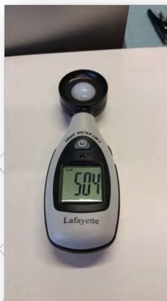
Misura con Luxometro Light metr LM - 1
