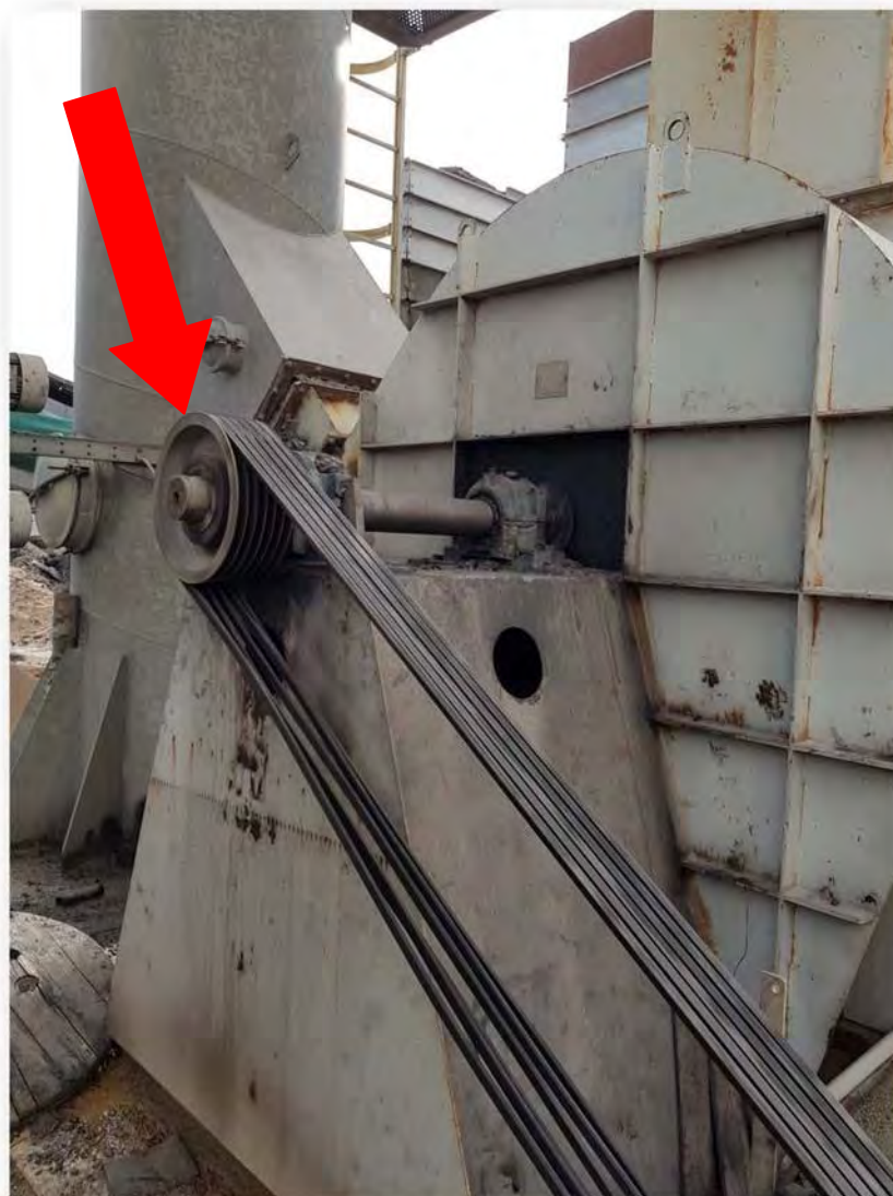
Cinghie trasmissione potenza scoperte
