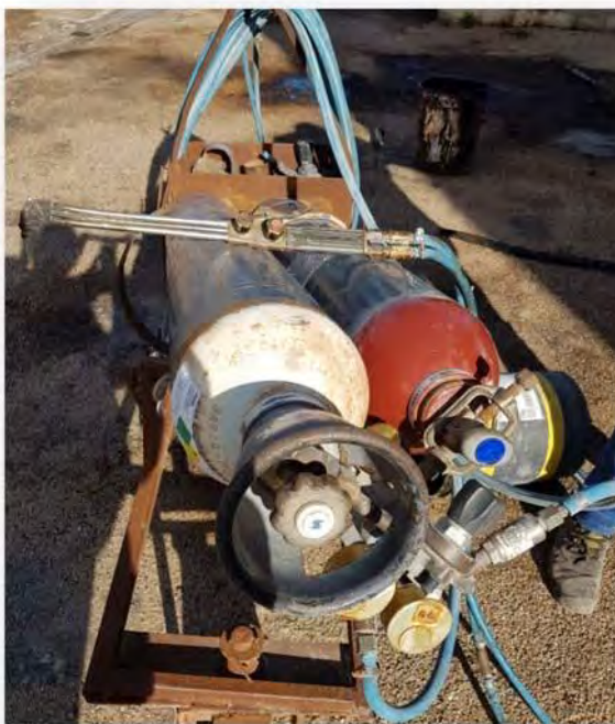
Postazione saldatura taglio ossiacetilenico
