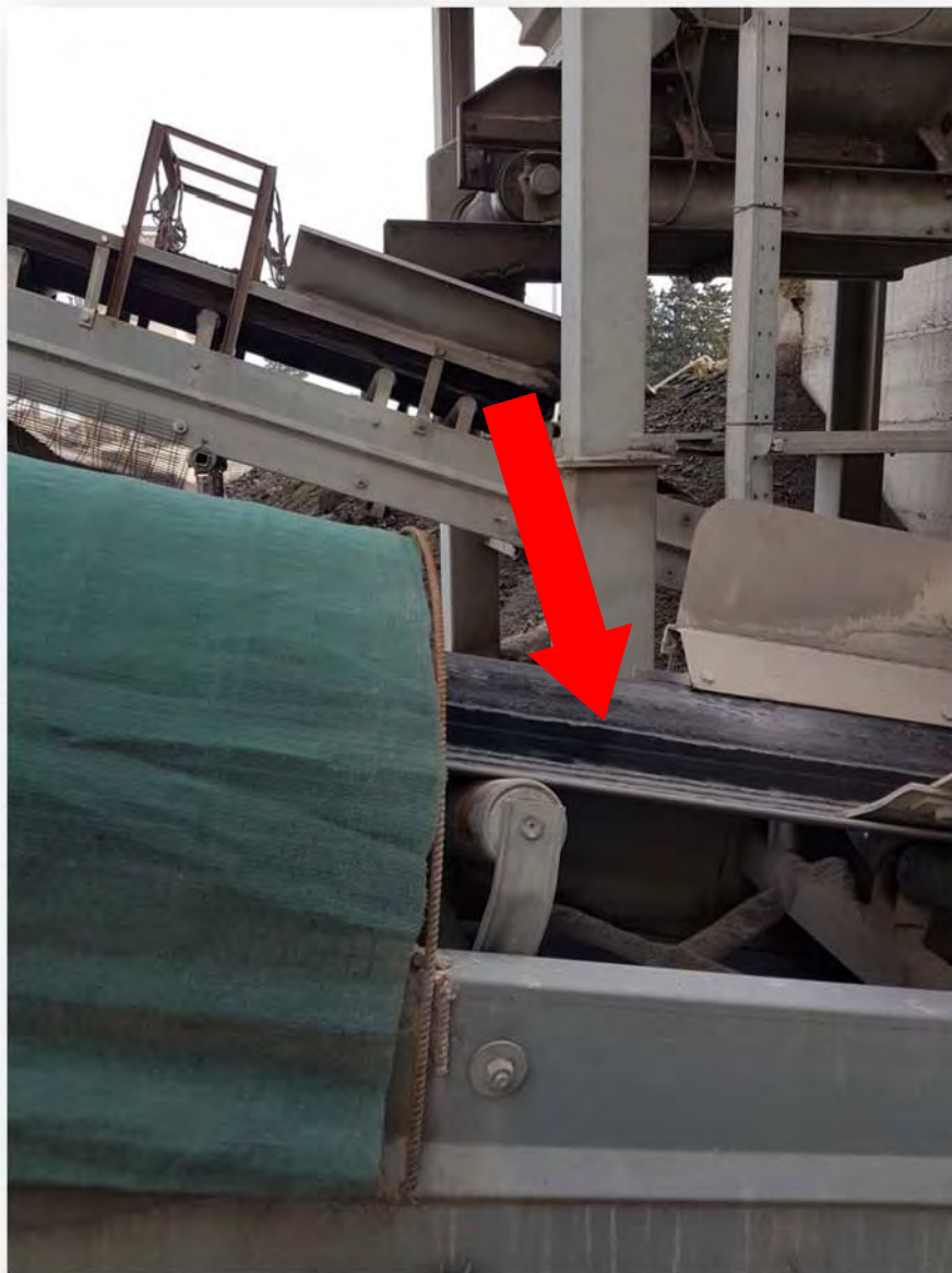
Nastro trasportatore privo di protezione
