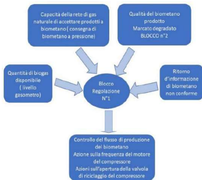
Schema 3: Schema del Blocco di regolazione n° 1
