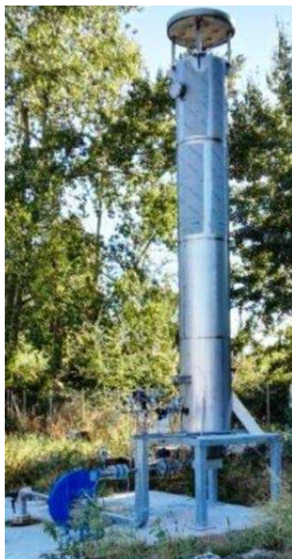
Immagine 2: Fotografie indicative dello scrubber-torre di lavaggio per l'abbattimento dell'ammoniaca (NH 3 )
