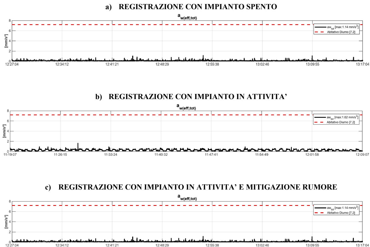
Figura 6. Accelerazioni efficaci ponderate totali registrate nel sito nelle 3 misure. La linea a tratteggio rosso indica la soglia ritenuta disturbante in condizione abitative diurne (6 am – 10 pm).
