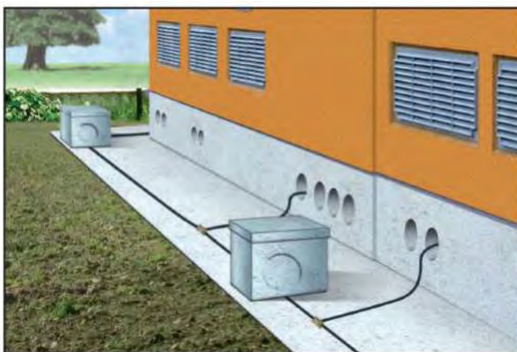
Rappresentazione di una tipica cabina di consegna secondo DG2092 particolari di condutture e realizzazione di impianto di terra locale
