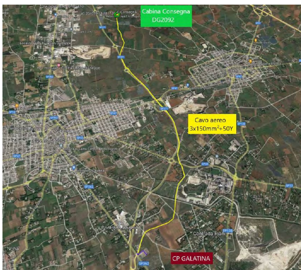
Figura 8 Rappresentazione del percorso di vettoriamento energia verso immissione in Rete Distribuzione
