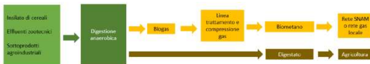
Figura 6 - Schema di flusso impianto a biogas per produzione di biometano liquido (configurazione di progetto)
