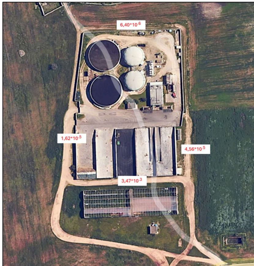
Figura 45 – Distribuzione valori di conducibilità idraulica k nelle calcareniti bioclastiche
