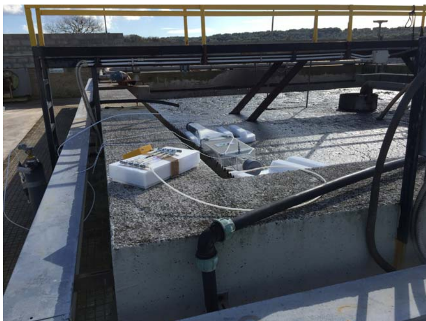
Foto 1: Campionamento da sorgente diffusa (vasca MOD_B)
