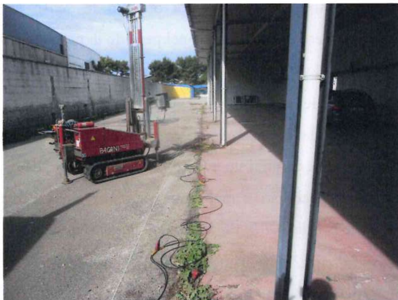
Prova di permeabilità in foro (eseguito con penetrometro superpesante)
