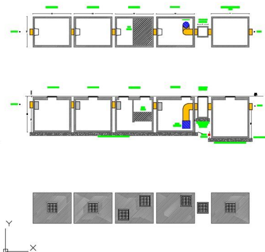
Figura 9: particolare impianto di trattamento e accumulo per il riutilizzo
