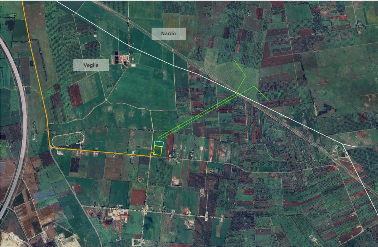
Figura 9. Localizzazione dell’area identificata per la realizzazione delle Opere di rete: poligono giallo = cabina primaria (CP) AT/MT “Torre Lapillo” 150/20 kV; poligono azzurro = stazione elettrica (SE) RTN a 150 kV; polilinee verdi = raccordi dalla SE alla linea RTN a 150 kV esistente denominata “CP S. Pancrazio Salentino - CP Porto Cesareo”. La polilinea arancione visualizza, invece, l’ultimo tratto del cavidotto di connessione MT (Fonte cartografica di base: Google Earth).
