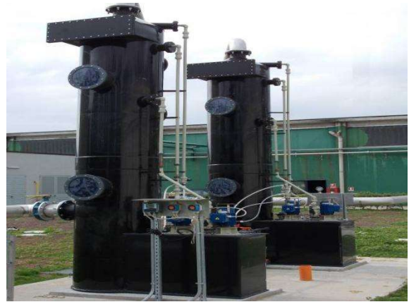
Figura 17-10 Torri di lavaggio del biogas
