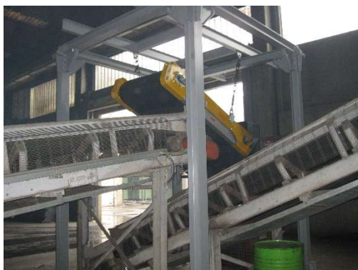
Separatore magnetico con struttura di sostegno
