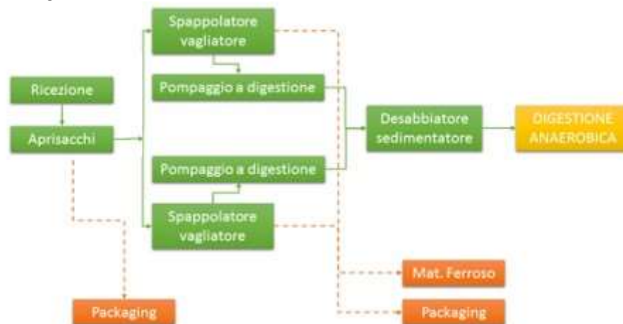
Schema di flusso dell'unità di pretrattamento
