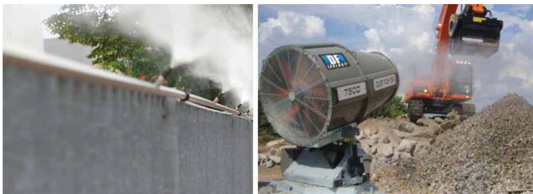
Figura 2: Sistemi di nebulizzazione per l'abbattimento delle polveri
