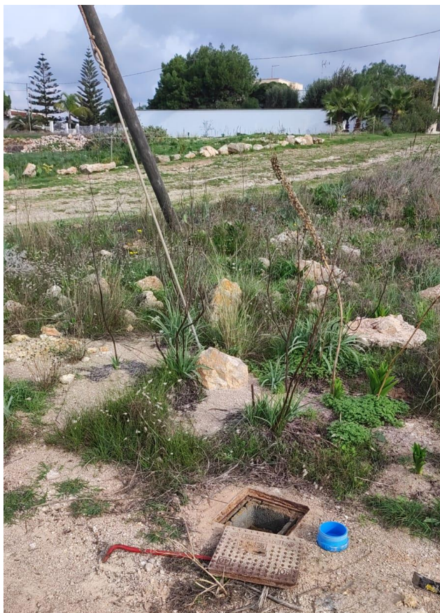
Figura 2-2 – Dettaglio del piezometro PZ7 individuato per il monitoraggio della falda a valle delle trincee.
