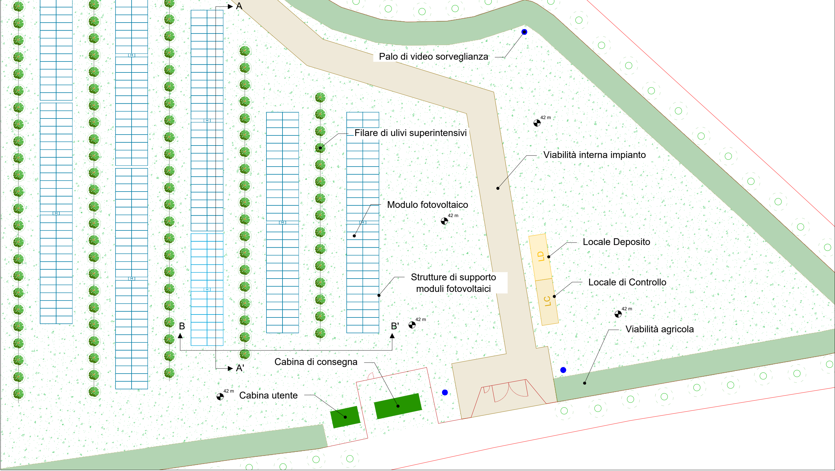
PARTICOLARE PLANIMETRIA DELL'IMPIANTO AGROVOLTAICO
