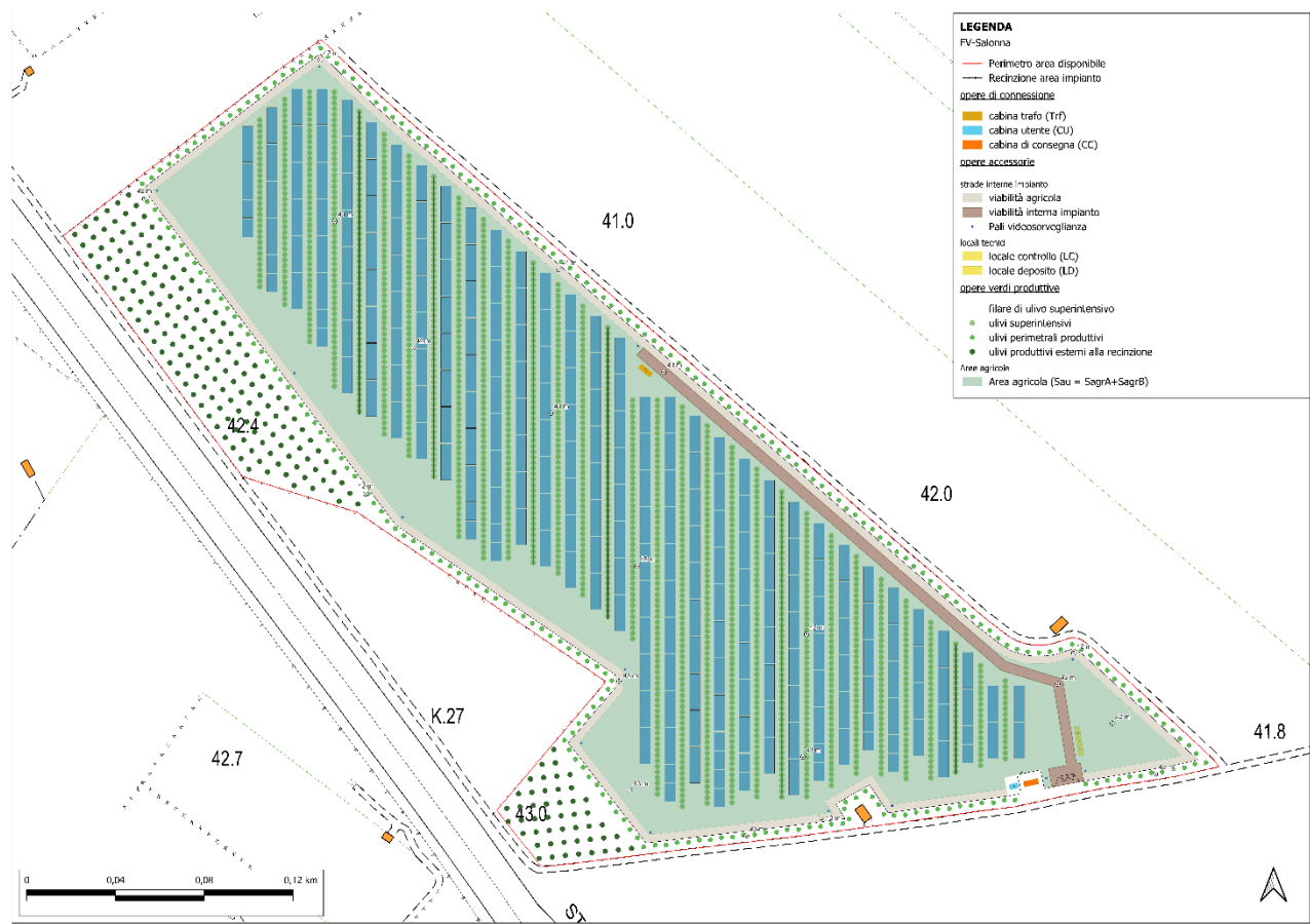
Figura 6-1 - Layout impianto agro-fotovoltaico FV-Salonna
